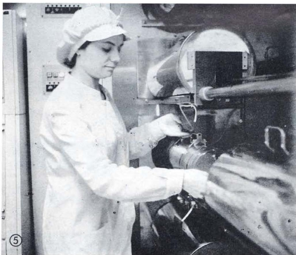
**Fig. 5. Uno dei passi del ciclo produttivo dei wafer a monocristallo: forno per l'ossidazione del wafer a 1100°C**
