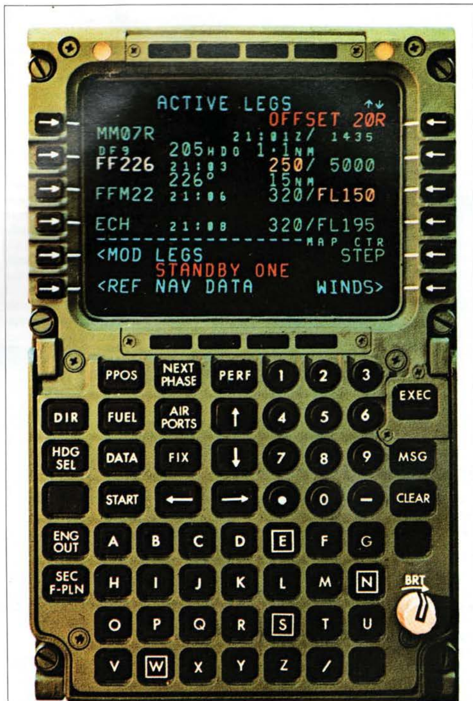
Il display del computer FMCS, permette al pilota di avere in brevissimo tempo tutte le informazioni che desidera circa le condizioni dell'aereo, e del volo. Questa è solo una delle molteplici funzioni svolte da questo computer.
