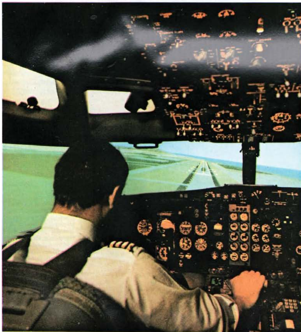
Un pilota si esercita in prove di simulazione di volo. La cabina di pilotaggio presenta caratteristiche reali: la vista esterna all'abitacolo è proposta da una serie di singoli schermi.
