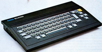
Il videogioco-home computer SG-3000. Prodotto dalla Casa giapponese Sega, presenta una tastiera completa con comandi cursore separati. Lo SG-3000 si interfaccia con qualsiasi televisore semplicemente inserendo l'apposito cavo di collegamento nella presa di antenna del televisore.
