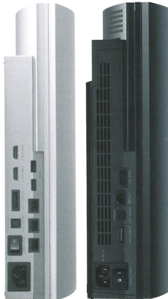
Diferencia entre el aspecto final y el diseño inicial de la PS3 (izquierda). Presentada en la E3 de 2005, la original incluía dos salidas HDMI para video simultáneo en varias pantallas. La mayor ventilación es otro cambio.
