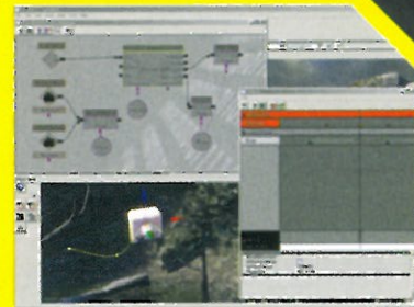
Una de las herramientas más importantes en Unreal Engine 3 es el sistema de escritura Kismet, para cablear juntos objetos y programas para crear juegos.
