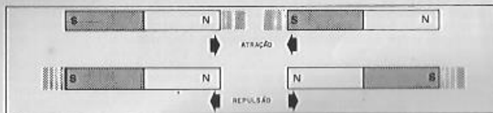
FIGURA 6 PÓLOS DIFERENTES SE ATRAEM E PÓLOS IGUAIS SE REPELEM
