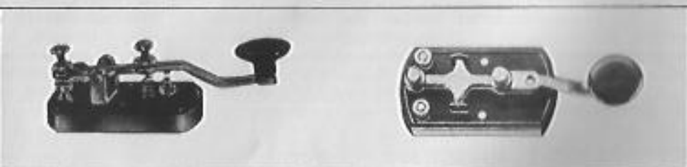
FIGURA 7 MANIPULADOR USADO EM TRANSMISSÕES TELEGRÁFICAS
