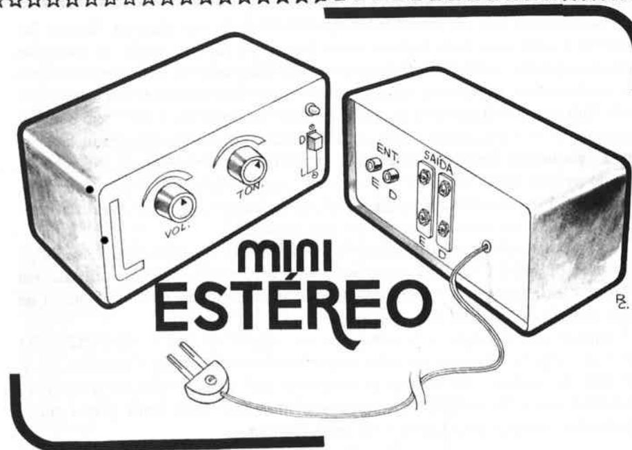
UM AMPLIFICADOR ESTÉREO COMPLETO, PARA USO RESIDENCIAL, DOTADO DE CONTROLES DE VOLUME E GRAVES/AGUDOS CONJUGADOS E INCLUINDO A FONTE DE ALIMENTAÇÃO! 5 WATTS DE ÁUDIO (2,5 + 2,5) COM EXCELENTE FIDELIDADE E SENSIBILIDADE! PODE SER ACOPLADO A MICROFONES, TOCA-DISCOS, TAPE-DECKS OU SINTONIZADORES!
