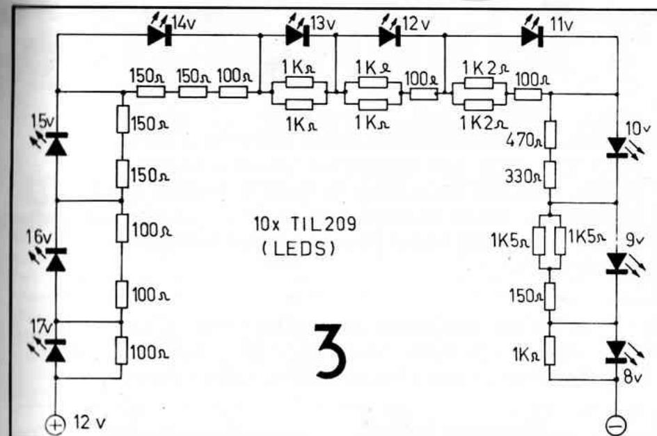
O fio marcado com ( - ) vai para o *negativo* da bateria do veículo, podendo então ser ligado a qualquer ponto de "massa". O fio ( + ) vai para o *positivo* da bateria do carro, mas de maneira que seja controlado pela chave de ignição, de maneira que o VOLTÍMETRO só funcione com o carro *ligado*. Essa precaução se deve ao fato do VOLTÍMETRO consumir (embora muito pouco...) corrente.
