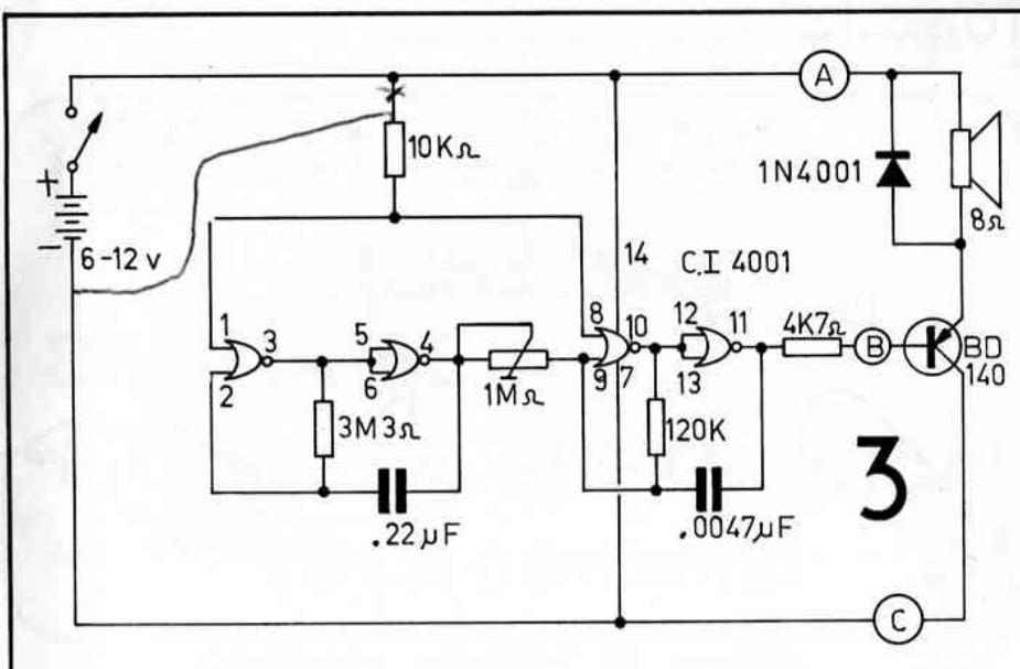
pág. 3 do Vol. 10), com o que a montagem ficará bem mais compacta. Se (conforme ilustrado) a construção for baseada na barra de terminais, aconselha-se a marcação – a lápis – dos números de 1 a 7 junto aos seus segmentos, para facilitar a identificação dos diversos pontos de ligação. Atenção à correta posição dos transistores e diodo.
