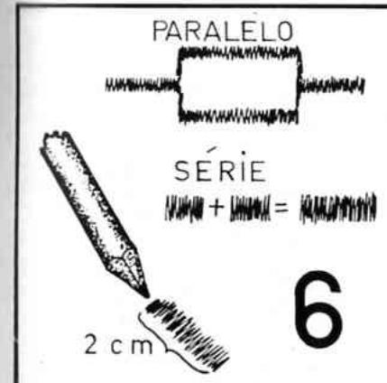
Uma aplicação prática, baseada na experiência descrita: quando um potenciômetro está fazendo ruído ao girar-se o cursor, é possível fazer-se uma "limpeza" da pista resistiva, com benzina, querozene ou fluido para isqueiros. Em seguida, bem levemente, passa-se um lápis macio (6B) na superfície da pista, que é recoberta de grafite. Com esse procedimento, o potenciômetro volta a funcionar completamente livre dos ruídos que fazia.
