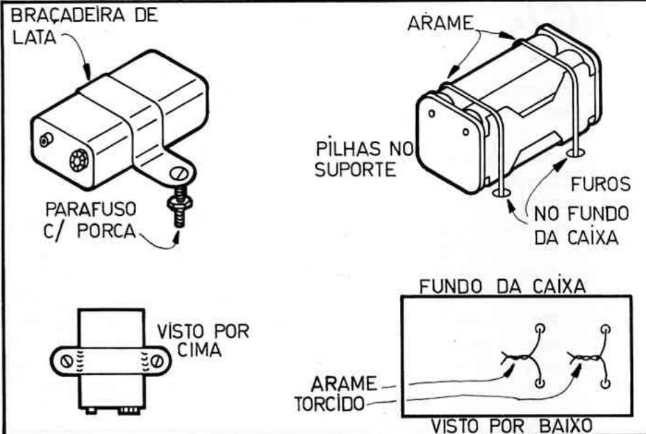
pedaços de arame relativamente grosso prendem facilmente o suporte com as pilhas. As extremidades dos pedaços de arame passam pelos furos e são torcidas pelo lado de fora da caixa. Aqui também vale o “truque” do pedaço de espuma de *nylon*, para evitar que o suporte fique “dançando”.
