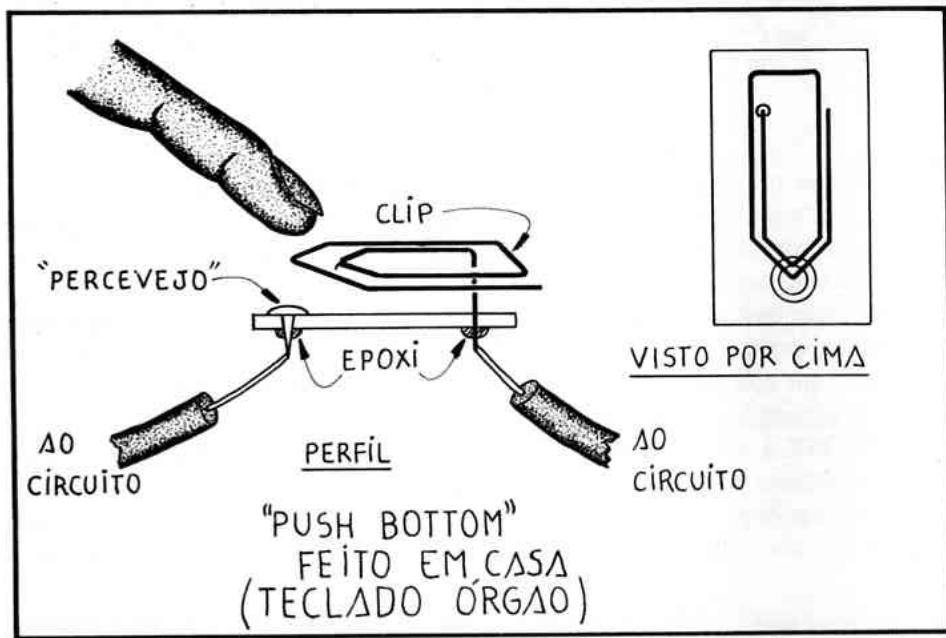
Dimensione as peças de maneira que o "clip" fique um ou dois milímetros acima da cabeça do "percevejo" (veja "perfil" na ilustração). Assim, uma leve pressão com o dedo sobre o "clip" será suficiente para colocá-lo em contato com o "percevejo", *fechando* o circuito. Por razões óbvias, o "clip" deve estar *bem acima* do "percevejo" metálico (ver o desenho "visto por cima"), para perfeito contato quando pressionado.
