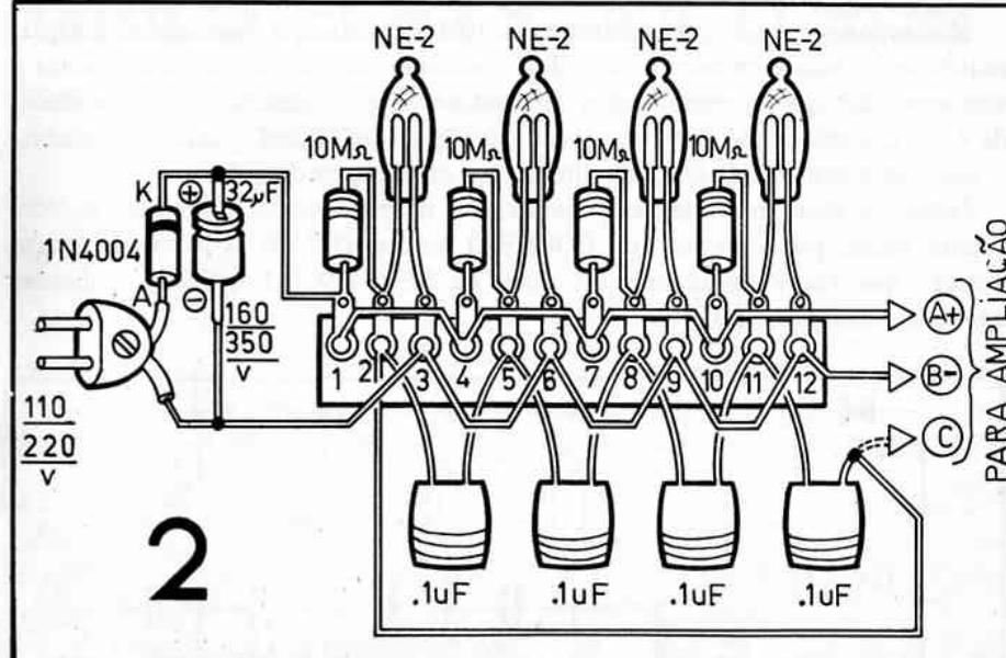
quantidade de lâmpadas acopladas ao circuito, o capacitor de  $.1\mu F$  ligado à *última* lâmpada da série (na junção dessa com o respectivo resistor de  $10M\Omega$ ) deverá retornar à *primeira* lâmpada da seqüência (sendo ligado também à junção dessa primeira lâmpada com o seu respectivo resistor de  $10M\Omega$ ).
