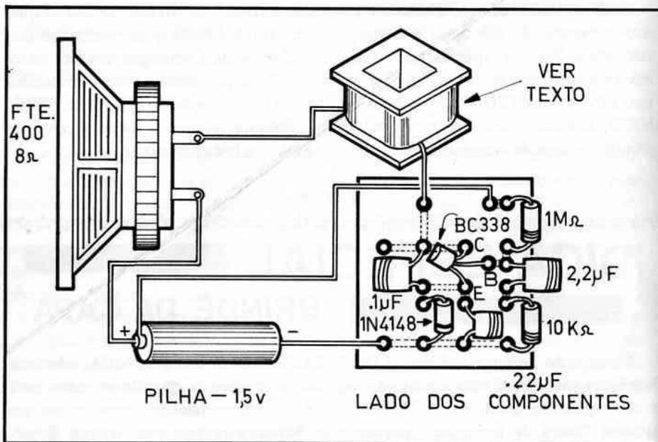
No primeiro desenho é vista a plaquinha do brinde, pelo lado das pistas cobreadas. O segundo desenho mostra a disposição dos componentes, pelo lado *não cobreado* da placaca. Basta colocar-se os componentes da maneira indicada, soldar-se com cuidado, cortar-se a "sobra" dos terminais e, finalmente, conectar-se o circuito à pilha que o alimenta, para que o GRILÓ comece a "cricrizar" (bem baixinho, como foi dito no artigo explicativo).
