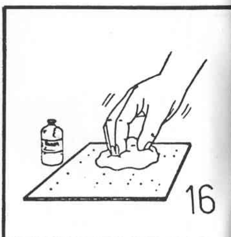
16 – Remova a tinta da traçagem, usando algodão embebido em acetona. Limpe novamente a placa com "Bom Bril".
