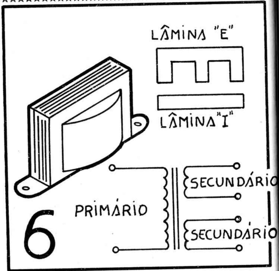
a um fenômeno chamado de "Correntes de Foucaud". Esses núcleos são constituídos geralmente de lâminas cortadas em perfis de "E" e "I", empilhadas para formar o que se denomina "ferro" do transformador. Nos espaços entre os perfis das lâminas ("janelas") situam-se as espiras do primário e do(s) secundário(s).
