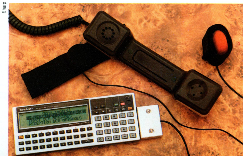
O modem TB-1360 MA permite a transmissão de dados de telefones públicos e rádios
