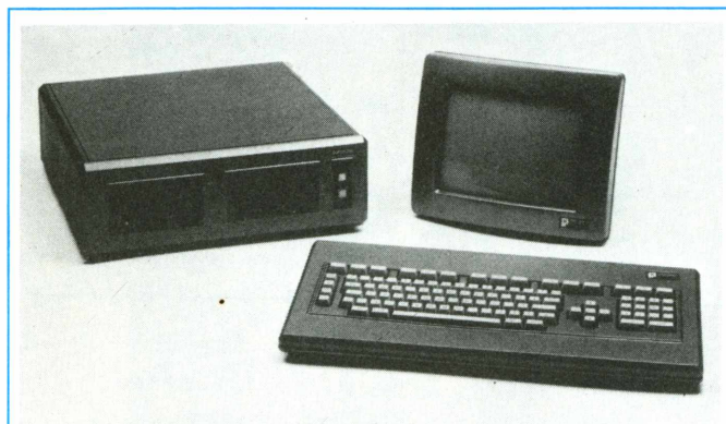
Super 700: máquina de 8 bits com quatro microprocessadores
