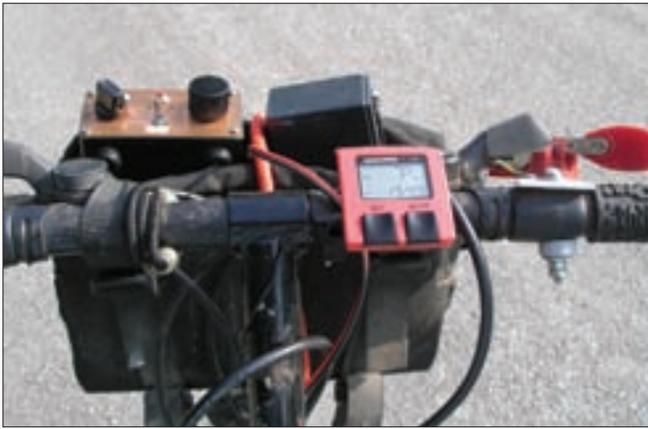
Foto 6. Una amplia vista del frontal de AC5K. El pequeño transceptor DSW Small Wonder va instalado en el lado izquierdo del manillar y la batería en el derecho, junto con un manipulador de palas iámbico para CW. La pantalla central es un mini-ordenador de bici que calcula la distancia, la velocidad, etcétera. (Foto cedida por AC5K).
