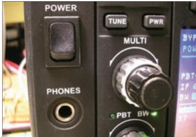
Foto D. El mando MULTI en la esquina superior izquierda de la pantalla del Omni VII lo controla casi todo, excepto aquellos parámetros que disponen de su propio mando (OFV, ganancia de AF/RF, y sintonía del ancho pasante), todos los demás se manejan por medio del mando que permite desplazarse por el menú y fijar los valores con el mando MULTI.
