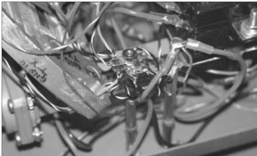
Foto A. Esta es una fotografía de la “tierra de protección” instalada en uno de mis montajes. Todos los cables de tierra de las placas individuales van a un único punto en el interior del chasis, y el chasis está conectado también a ese punto.
