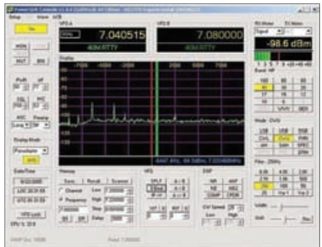
Foto C. Ventana principal del programa Power SDR, desarrollado por Flex-Radio y funcionando sobre un receptor SoftRock en la banda de 40 metros, de la que se monitorizan 10 kHz a cada lado de la frecuencia de sintonía.
