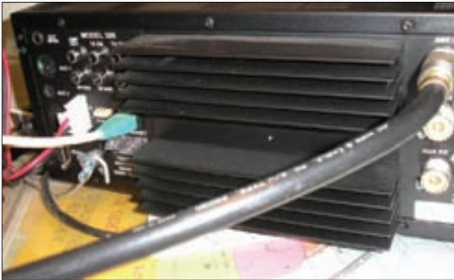
Foto B. Vista posterior del Omni VII. Dispone de conectores para dos antenas, aparte de otro más para una antena auxiliar de recepción (como por ejemplo una antena de aro para bandas bajas), así como un gran disipador.
