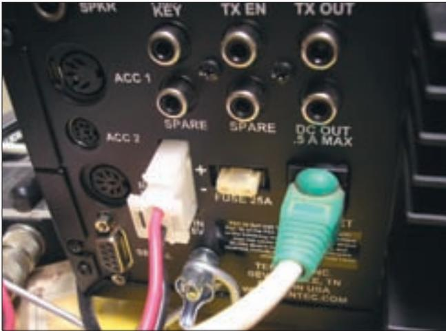
Foto E. Aquí tenemos lo que distingue al Omni VII de otros equipos del mercado: un conector Ethernet (conector verde) a la derecha del panel posterior. También se ve aquí la entrada de 12 Vcc y unos cuantos conectores para accesorios.
