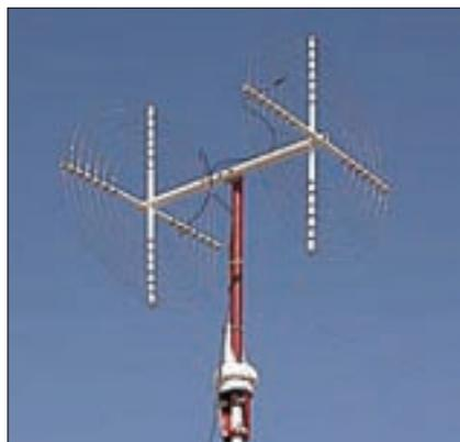
Foto C. La antena TAK-tenna es un dipolo acortado para 40 metros que mide solamente 75 cm de lado a lado. La antena utiliza una espiral de hilo de cobre plateado a cada extremo para reducir sus dimensiones sin utilizar bobinas (Foto cedida por TAK-tenna).
