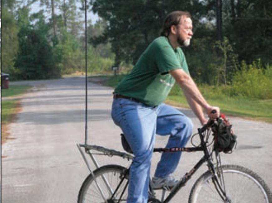
Foto 4. Siguiendo el camino de la construcción casera, Wes Spance, AC5K ha conseguido muy buenos contactos DX con su bici-móvil. Su instalación consiste en un transceptor para 20 m DSW Small Wonder Labs de 2 vatios y una batería instalada en el manillar, junto con una antena HamStick, además de unos paneles solares en el portapaquetes posterior para recargar la batería. (Foto cedida por AC5K).
