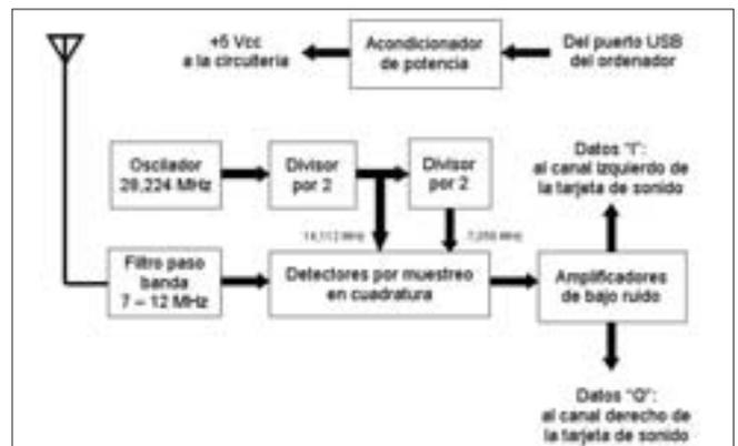
Figura 1. Diagrama de bloques de un receptor *SoftRock* para 40 o 20 metros. La señal del oscilador es dividida en frecuencia y aplicada a un detector en cuadratura; las señales en fase (I) y en cuadratura (Q) resultantes se envían a las entradas L y R, respectivamente, de la tarjeta de sonido de banda ancha del ordenador.
