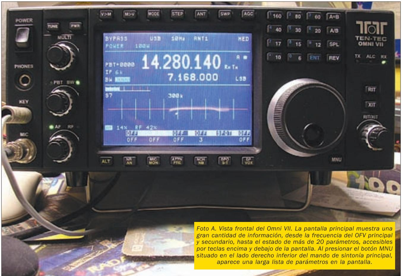
Foto A. Vista frontal del Omni VII. La pantalla principal muestra una gran cantidad de información, desde la frecuencia del OFV principal y secundario, hasta el estado de más de 20 parámetros, accesibles por teclas encima y debajo de la pantalla. Al presionar el botón MNU situado en el lado derecho inferior del mando de sintonía principal, aparece una larga lista de parámetros en la pantalla.
