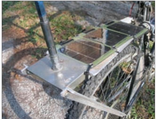
Foto 7. Una vista más próxima de los paneles solares en la parte posterior de la bicicleta de AC5K. Estos paneles de excedente militar fueron utilizados como recargadores de vehículos militares Hum Vee.
