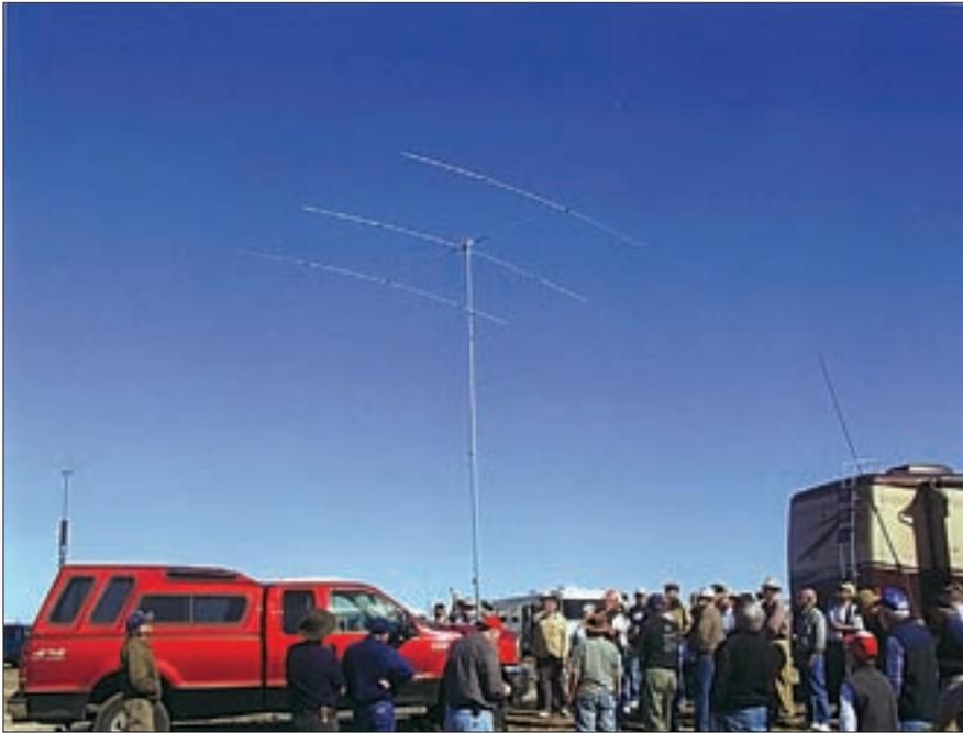
Foto B. La nueva antena comercializada por W6MMA es una antena portable para seis bandas, concretamente una Yagi de 3 elementos con un mástil opcional de 6 metros y que extiende fácilmente sus elementos. Tanto los elementos telescópicos como la viga que los soporta permiten ser transportados en una bolsa de 90 cm y montarse en unos 5 minutos (Foto cedida por W6MMA).
