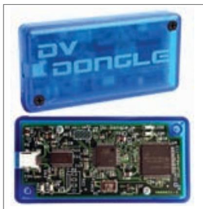
Foto E. El codificador/descodificador DV Dongle permite conectarse a la red D-STAR sin necesidad de un transceptor D-STAR. Aquí tienes una fotografía de su interior y exterior (Más información en: [www.hamradio.com](http://www.hamradio.com).)
