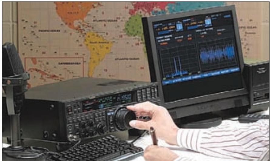
Foto B. El equipo “de ensueño” Yaesu FT-950 muestra la pantalla del accesorio opcional DMU-2000 (Data Management Unit), el lujoso micrófono dinámico MD-200, el teclado de control remoto FH-2, un monitor LCD y un teclado comerciales.
