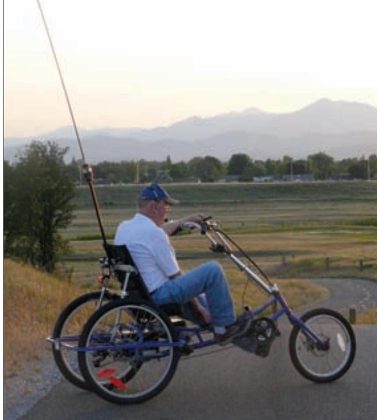
Foto 3. Esta vista adicional de la bicicleta de W3FF nos revela la limpia instalación realizada, mientras contemplamos el acoplamiento de la antena. La nueva BuddiStick es una antena de látigo de impresionante aspecto militar montada sobre su bobina. El látigo se compone de secciones de 53 cm enroscadas entre sí, que proporcionan longitudes desde 1,60 con tres secciones hasta 3,7 metros con siete secciones. (Más detalles en <[www.buddipole.com](http://www.buddipole.com)>).
