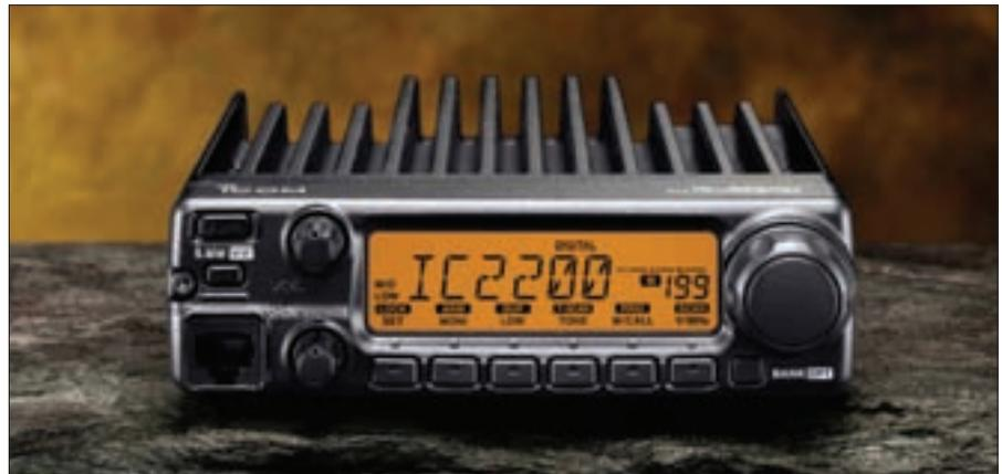
El nuevo equipo de ICOM el IC-2200 es un monobanda que saca 65 vatios en 2 metros y te da la opción de añadir el sistema de datos y digital D-STAR (Foto cortesía de ICOM America).
