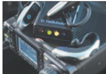
Foto K. El TalkSafe, mostrado aquí encima de un transceptor ICOM; enlaza casi cualquier dispositivo Bluetooth o auricular/micrófono inalámbrico para teléfonos móviles con casi cualquier transceptor de HF/VHF/UHF, para una operación "manos libres". Puede ser empleado en el interior o el exterior de un vehículo o estación fija.
