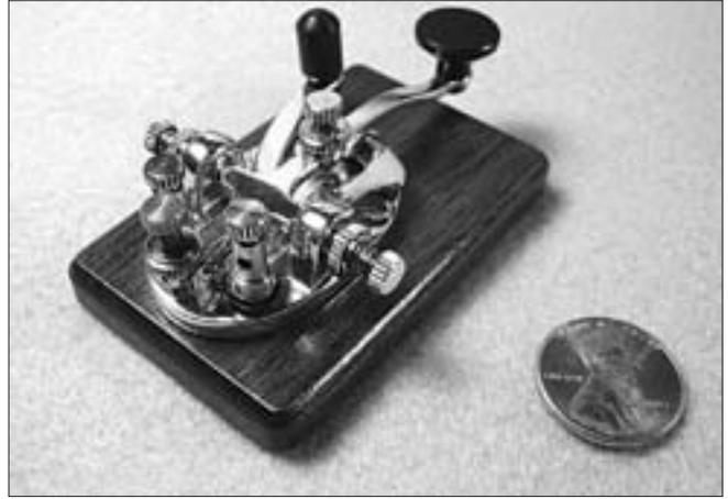
Foto 5. Muchos radioaficionados recordarán con nostalgia sus comienzos en la CW con un manipulador J-38 como esta reproducción a tamaño reducido, con idénticos detalles que su original, hecha por Lee Hutchins, KA6IRL. Más detalles en <www.qrpj38.com>.
