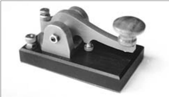
Foto 4. Uno de los estilos de manipulador más apreciados a lo largo del tiempo es el "Camelback" (jiba de camello), y esta versión miniatura (37x70 mm) está fabricada hecha por Englmar Wenk, DK1WE y es una auténtica joya digna de estar en la vitrina de cualquier coleccionista.
