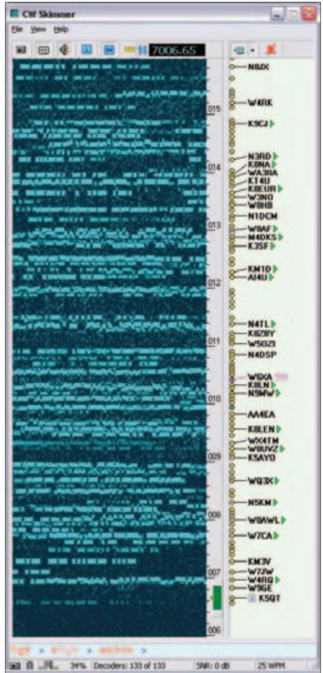
Foto C. En un pileup y con la misma tarjeta de 24 bit, y a pesar de la gran cantidad de señales presentes, en un segmento de banda de 10 kHz es posible encontrar dos o tres huecos (7006.65, 7011.65 y 7015.50 por ejemplo) donde situarnos. La etiqueta "599" que aparece junto a W6GA nos indica donde está escuchando la estación DX.
