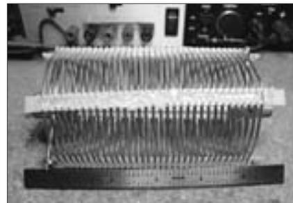
Foto D. La bobina con núcleo de aire, terminada.
