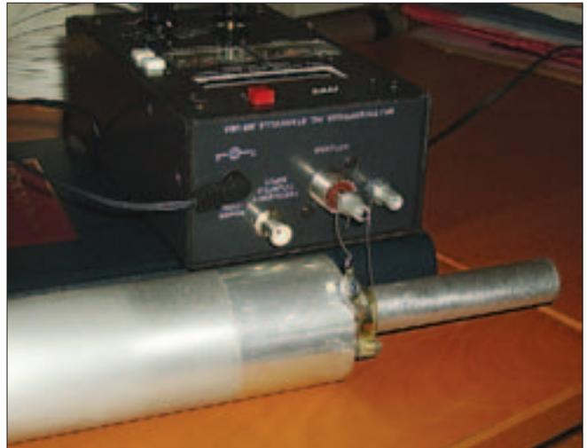
Foto B. Para medir la inductancia de cada una de las bobinas se debe levantar el extremo del hilo que va unido al cilindro y efectuar la medida entre este punto y el tubo interior, empleando conexiones lo más cortas posible.
