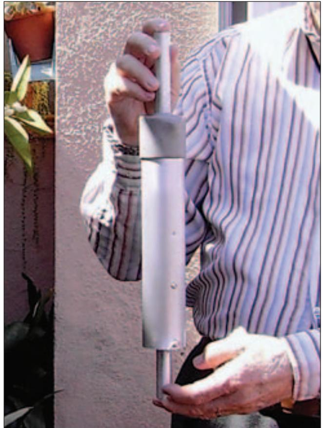
Foto A. La unidad CT2 es uno de los tres juegos de trampas que se utilizan en la antena R-7000 de Cushcraft para efectuar automáticamente la conmutación de bandas. El capacete superior debería impedir la entrada de agua en el interior. En la foto se aprecia uno de los tornillos autorroscantes que sustituye a la hendidura original (ver texto).
