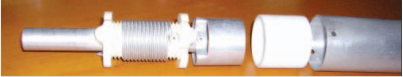
Foto C. Retirados los tornillos de fijación y eliminadas las hendiduras existentes en el cilindro, se puede extraer el conjunto. El hilo de la bobina está fuertemente devanado sobre una forma ranurada en espiral y en el extremo superior se añade un cilindro de aluminio, forrado con otro de teflón, que actúa como capacidad adicional. El problema de la antena radicaba en el remache que une el cilindro al tubo interior, que atraviesa todo el conjunto.
