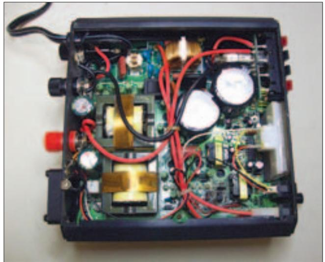
Foto C. Interior del DM-330MV de Alinco. Aunque no es demasiado obvio, esta unidad en concreto sufrió el impacto de una descarga de rayo y Larry Lowry, WD5CFJ tomó una foto para nosotros cuando la analizaba.
