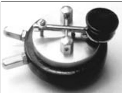
Foto 6. Eche una mirada a este curioso manipulador de base circular. Su brazo está fabricado a partir de una llave, perforada para dotarla de un eje y de una empuñadura de madera de cocotero. La original la fabricó Jim Richards, K6VDH y actualmente la distribuye Morse Express. Otro lujo para coleccionistas.
