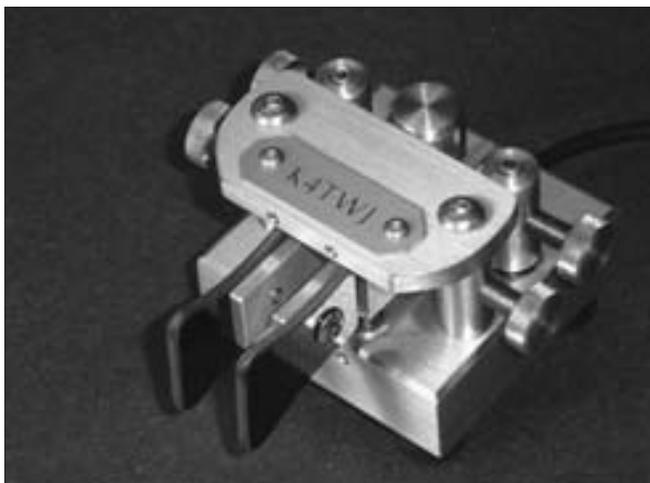
Foto 1. Este sorprendente y pequeño manipulador iámbico lo fabrica Tony Baleno, N3ZN, e incorpora tensionado magnético, brazos de respuesta rápida y está montado sobre una base lacada que mantendrá su aspecto de nuevo durante mucho tiempo. Se le denomina "QRP Paddle" y se puede conseguir en <www.n3ankeys.com>.
