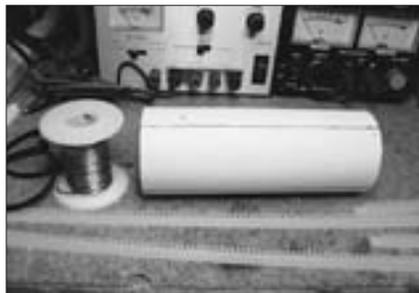
Foto A. Tramo de tubería de PVC marcado y listo para añadir las tiras de nylon.
