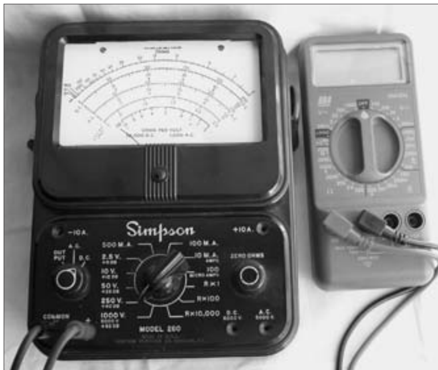
Foto A - Dos ejemplos fácilmente reconocibles de multímetros son los modelos 260 de Simpson (análogo) a la izquierda y el DM-15XL (digital) a la derecha. Soy muy parcial a favor del Simpson porque mi padre diseñó el primer modelo de pruebas del 260.
