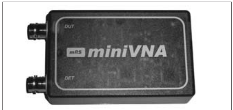
Foto D - El analizador miniVNA es un dispositivo definido por software que está disponible en <www.w4rt.com>. El instrumento se conecta a un ordenador por USB y muestra en la pantalla los parámetros seleccionados (frecuencias de barrido, ROE, ancho de banda para 2:1, etcétera). (Foto cedida por Barry Jonson, W4WB).
