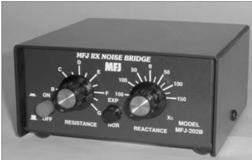
Foto B -El asequible puente de ruido MFJ-202B funciona junto con un receptor o transceptor para medir la frecuencia de resonancia de una antena, la resistencia en el punto de alimentación y la reactancia inductiva o capacitiva. Puesto que es muy pequeño y barato, algunos colegas le llaman el analizador de antenas “de pobre”.
