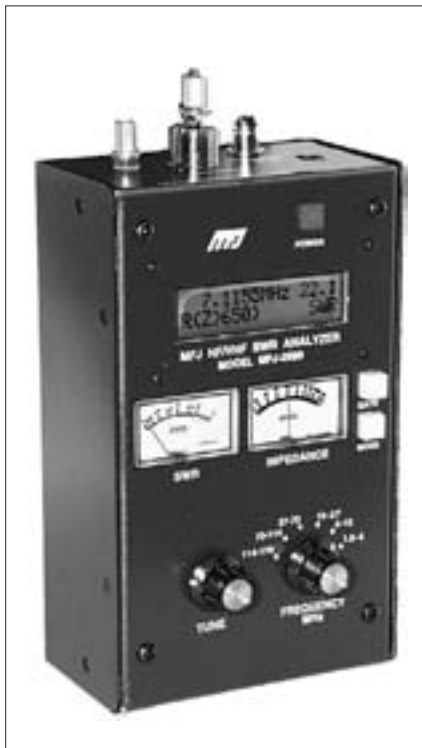
Foto C - El popular instrumento MFJ-259B es un analizador de antenas que mide la frecuencia de resonancia, la impedancia y la resistencia de una antena, además de las pérdidas de un cable coaxial, sus posibles fallos, etcétera. El dispositivo cubre desde 1,8 a 170 MHz e indica la ROE y la impedancia en instrumentos separados, aparte de la frecuencia de resonancia y la reactancia en un indicador LCD. Contiene una pila interior de forma que puedes presintonizar una antena antes de poner en marcha el transmisor. (Foto cedida por MFJ Enterprises, Inc).
