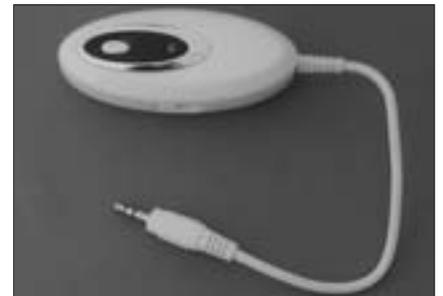
Foto E. ¿Quiere darle otro aire a su operación de radio en móvil? Enchufe en la toma de auriculares de su transceptor el jack de este pequeño y barato transmisor FM en la banda de 88 MHz y sintonice su autorradio en su frecuencia para lograr un sonido de "gran estación".
