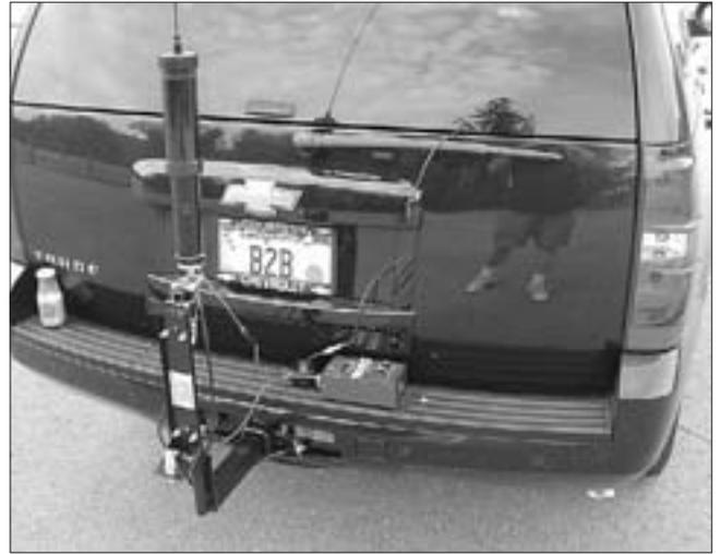
Foto G. La antena móvil de sintonía a tornillo High Sierra 1800 es bastante grande y pesada, por lo que Rick preparó un arnés especial "estilo camión" para soportarla en la parte trasera de su monovolumen Tahoe.
