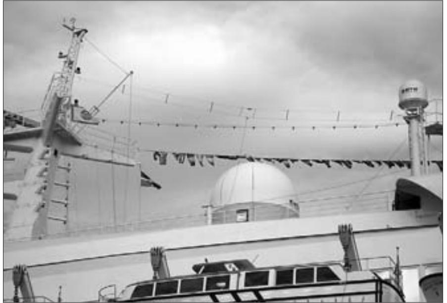
Foto D. Mirando atentamente podemos apreciar, encima de la línea de gallardetes de señales, la antena T2FD de la estación de Marius, extendida entre dos soportes elevados, por encima de la cubierta superior. Bajo las cúpulas blancas están las parábolas del servicio de satélites (TV y telefonía internacional).
