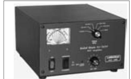
*La irrupción de los semiconductores en los amplificadores de potencia, tal como este ALS-600 de Ameritron ha suprimido la necesidad del proceso de ajuste de la carga del paso final, siempre engorroso.*
