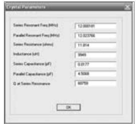
Foto H. Los parámetros de un cristal de 12 MHz.
