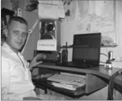
Foto C. Marius ante su instalación "no profesional" a bordo del *Holiday Dream*. Consiste en un Kenwood TS-690, una fuente de alimentación y un ordenador portátil para el registro de QSO con un teclado extra. Se puede oír a YO4HGX/mm en 30 y 40 metros y es un excelente operador de CW.
