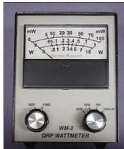
Foto C. Vatímetro WM-2 de OHR, pensado para el QRPista. Tiene tres escalas, de hasta 10 vatios, 1 vatio y 100 milivatios.
