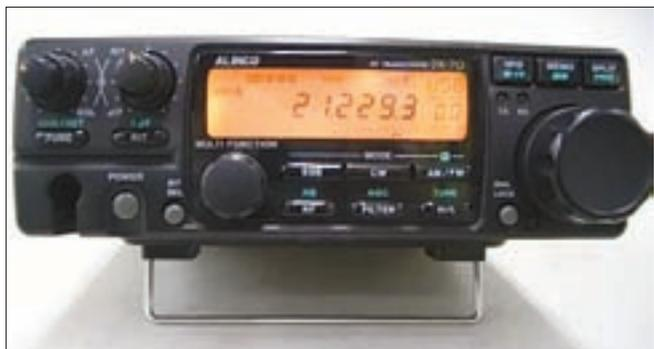
El DX-70 de Alinco cubre la HF más los seis metros e incluye un frontal separable (como otros muchos equipos) permitiendo instalar el equipo en el maletero u otro lugar discreto. (Foto cortesía de Alinco)
