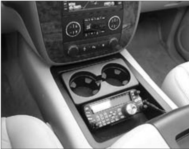
Foto F. El panel frontal del TS-480SAT, visto desde el asiento del conductor en el auto de Rick, K6VVA. El panel es orientable para una óptima visión y puede ser retirado y escondido en un instante por razones de seguridad, mientras que el cuerpo principal de la radio está instalado permanentemente en el espacio posterior del coche.
