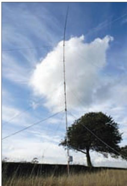
Foto A. Antena vertical para DX en bandas bajas de DBL Antennas; mediante sintonía remota, cubre las bandas entre 160 y 20 metros (ver texto).
