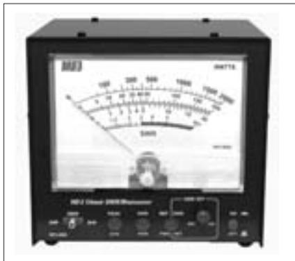
*Este vatímetro con tres escalas entre 20 W y 2 kW puede medir alternativamente potencias media o de pico y la relación de ondas estacionarias ROE (SWR), pero para esta última requiere tarar el instrumento.*
