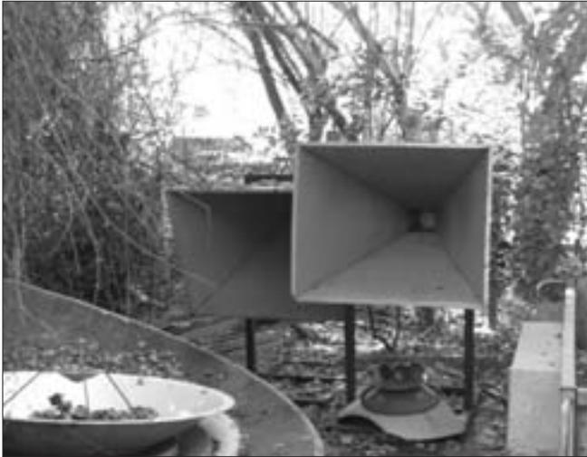
Foto B. Algunas de las antenas de bocina y parábola empleadas por el BAA RAG en sus proyectos de radioastronomía.
