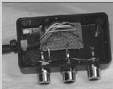
Foto E. Cableado de la interconexión para el IC-706MKIIG.
