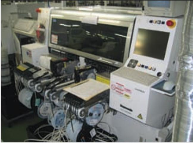
*Esta máquina coloca los componentes en las placas. Las cintas traen los componentes, que son colocados con gran precisión y rapidez.*
