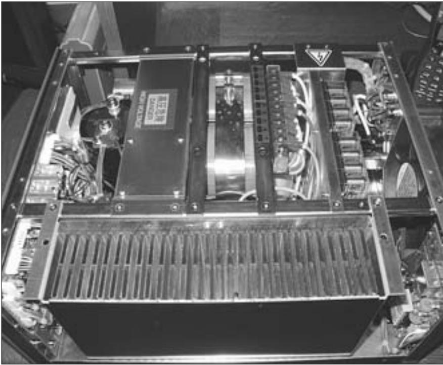
Foto B. Vista interior del amplificador. Toma nota del inmenso disipador en la parte posterior.
