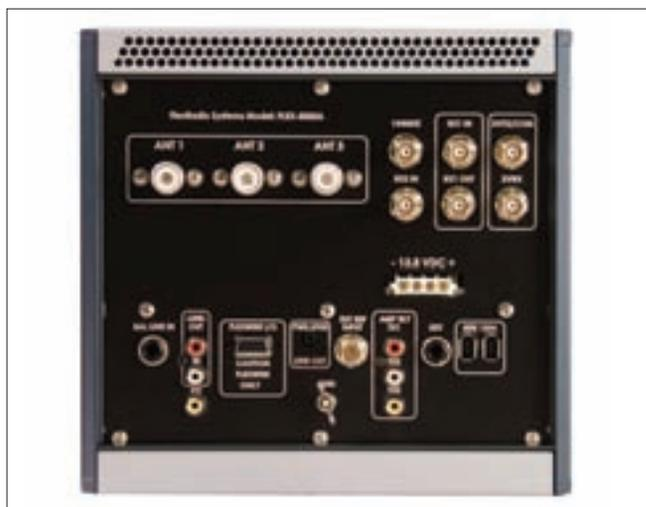
Figura 2. Vista del panel posterior de la radio SDR FLEX-5000A, donde se sitúan todas las vías de entrada y salida de la radio, salvo del micrófono y auriculares, que están en el panel frontal.
