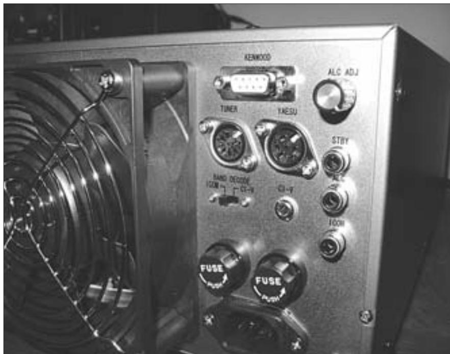
Foto D. Ampliación de los conectores rotulados de interconexión del lineal con los transceptores. Todos los cables están incluidos para intercambiar directamente la información de la banda para la mayoría de equipos ICOM, Kenwood y Yaesu.
