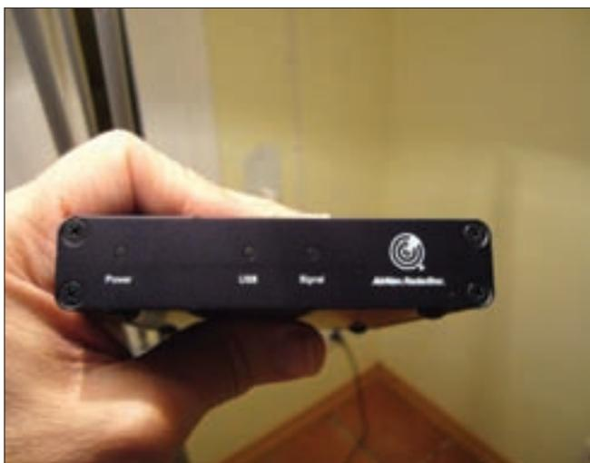
Foto A. Vista frontal del módulo AirNav RadarBox. Tres indicadores a LED muestran el estado.
