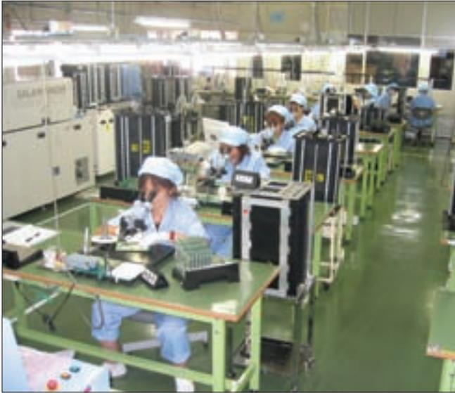
Algunos de los controladores de calidad que inspeccionan los circuitos ya montados utilizando microscopios.
