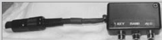
Foto F. Exterior de la interconexión para el IC-706MKIIG.
