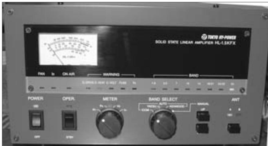
Foto A. El HL-1.5KFX de Tokyo Hy-Power proporciona 1000 W de salida desde 1,8 a 30 MHz y 600 W en 50 MHz.
