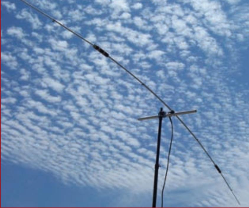
Foto D. El dipolo rotativo para 30 metros montado con las bobinas de carga de la YP-3.
