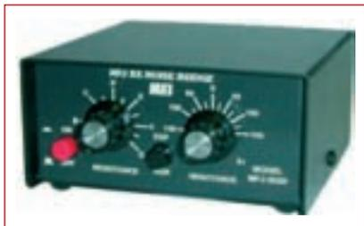
Para conocer la frecuencia de resonancia de una antena, basta con conectar el puente entre el punto de alimentación y el transceptor: el puente producirá ruido en todo el margen de recepción del equipo, con el que buscaremos la frecuencia de mínimo ruido. Seguidamente, para conocer la resistencia de la antena en su punto de resonancia, actuaremos sobre el mando de resistencia del instrumento hasta eliminar el ruido, y leeremos en la escala del mando la resistencia de la antena.
