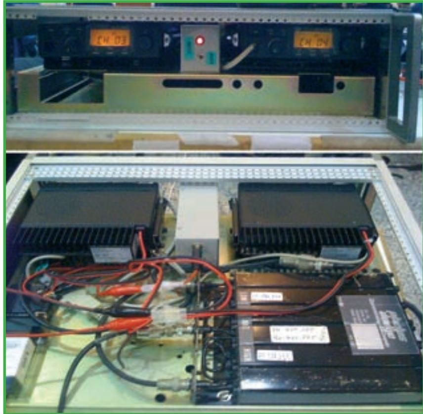
Foto A. Vista frontal y superior de la maqueta diseñada por Jonathan García, EA1HET, presentada oficialmente en el Congreso de la URE de 2008, y en la que se podían observar dos transceptores conectados a un sistema Asterisk.
