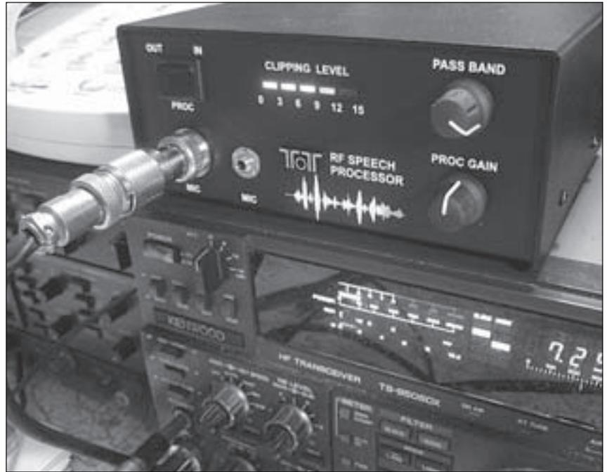
**El procesador de audio de Ten-Tec modelo 715 RF no sólo ajusta la respuesta de audio de tu transceptor, sino que realmente lo convierte en una señal de banda lateral única, que luego filtra y recorta, antes de convertirla de nuevo en audio que envía a la entrada de audio de tu equipo. El resultado es una mayor potencia media de salida, junto con un audio que suena mucho más lleno.**
