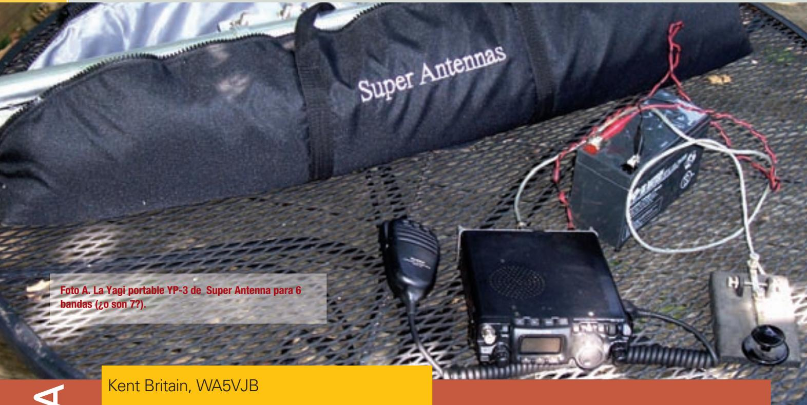
Foto A. La Yagi portable YP-3 de Super Antenna para 6 bandas (¿0 son 7?).
