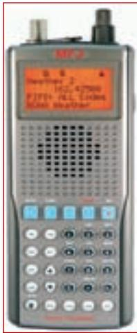
En cuanto al MFJ-8322 (foto A), es un receptor portátil con las mismas bandas que el 8310 más las bandas de aficionado de 222 MHz (EEUU) y 1240-1300 MHz, la banda de servicios de 800 MHz y frecuencias de aviación militar (MFJ no da detalles sobre estas últimas).
