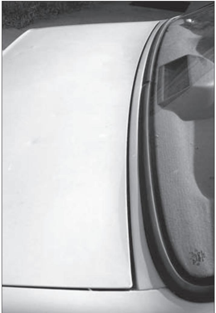
Fotos C.- Utilización de partes de un vehículo como antenas de ranura.
