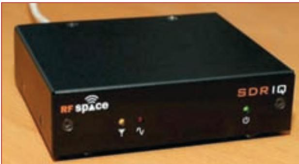
Foto A. El SDR-IQ, un receptor de 0,1 a 30 MHz que cabe en la palma de la mano. Fuente: RF Space.
