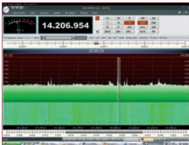
Foto E. Escuchando a A41MO en la banda de 20 metros en SSB, con un SDR-IQ y el programa SDR-Radio (ver texto).
