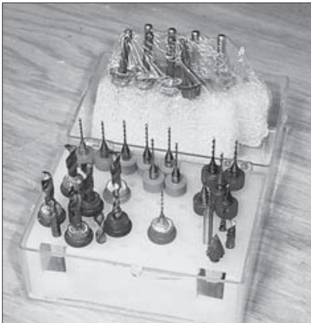
Foto D. Un juego de brocas de acero al carbono. Son todas muy duras y permiten perforar millares de agujeros en una placa tan abrasiva como las de fibra de vidrio-epoxy de los circuitos impresos, pero son muy frágiles y se quiebran fácilmente si se utilizan en un taladro manual.
