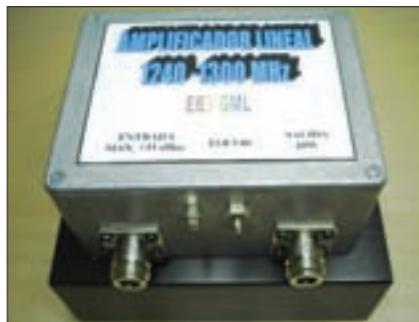
Amplificador lineal de EB3GML para ATV (1240 a 1300 MHz). Potencia de entrada: 1 vatio; potencia de salida: 20 vatios.
