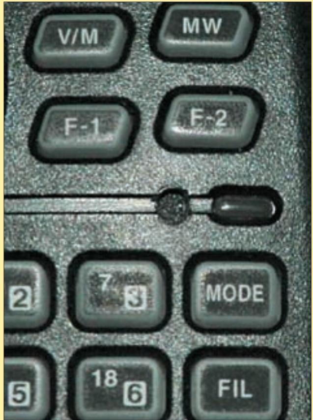
Foto C. Una de las modificaciones sugeridas para mejorar la respuesta del HM-151 consiste en agrandar a un diámetro de 2,5 mm el orificio de captación acústica de la carcasa, modificación que se realiza muy fácilmente desmontando ésta con cuidado, retirando el circuito impreso y separando del fondo la placa de goma de las teclas. (Foto cortesía de EB5HEJ)
