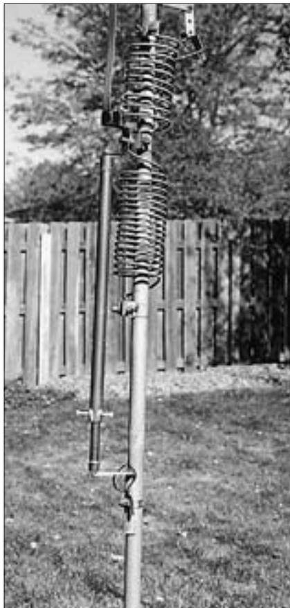
Foto D. El condensador terminado y montado en la antena.
