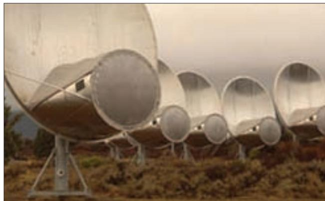
El Allen Telescope Array lo forman actualmente un conjunto de 42 antenas parabólicas sincronizadas, que llegarán a ser 350 cuando finalice el proyecto.
