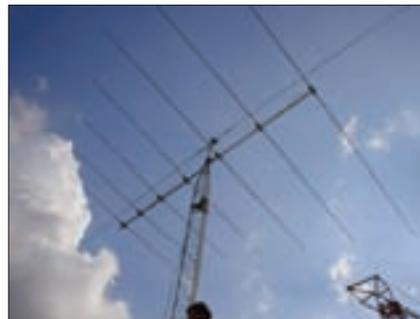
Foto F. Antena log-periódica de 7 elementos de Simagal Antenas. Cubre de 13,5 a 30 MHz y su ganancia media es de 7,9 dBi (5,8 dB sobre dipolo).
