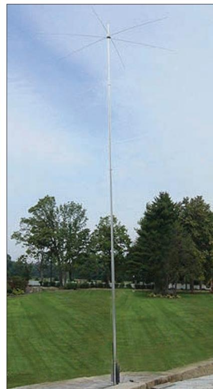
Foto E. La 40VA-1 de DX Engineering es una antena vertical monobanda para 40 metros. Se observa la carga capacitiva superior, gracias a la que el rendimiento de la antena es bueno en 40 metros con tan sólo 7,2 metros de altura.
