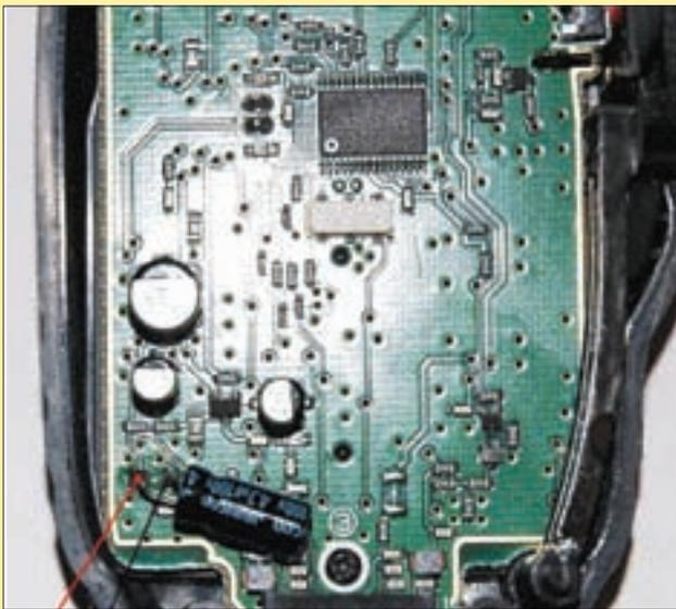
Foto D. Cambiando el condensador original de 1  $\mu\text{F}$  por otro de 4,7  $\mu\text{F}$  se mejora apreciablemente la respuesta global del micrófono. Es necesario respetar la polaridad, tal como se muestra en la foto. (Foto cortesía de EB5HEJ.)
