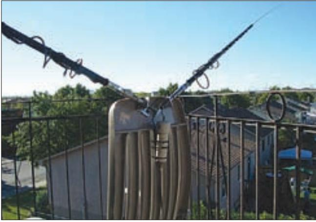
Foto C. Pierre Bordeleau, VE2OPB, vive en una comunidad de apartamentos con sólo una terraza para instalar la antena. ¿Qué podía hacer? Instaló dos látigos móviles multibanda Outbaker en una silla y adaptó un balun al centro. La terraza está en un cuarto piso y domina la vecindad, de modo que la antena radia una buena señal en esas direcciones. (Foto cedida por VE2OPB).
