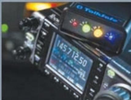
Debido a esto la integración de Bluetooth con equipos analógicos necesita una etapa de conversión adicional para proporcionar un camino adicional a la señal analógica que permita la interconexión con la salida a un altavoz analógico y la entrada de micrófono analógico de equipo con la multitud de dispositivos Bluetooth disponibles. Esto ha sido, me parece, el factor limitante debido a mercado relativamente reducido de los equipos de radio privados y de aficionados.
