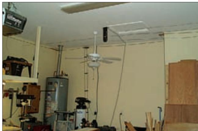
Foto B. Una vista de la antena de Dave escondida en el garaje. La línea de alimentación paralela a la derecha del calefactor de agua se extiende a lo largo de las paredes del garaje hasta alcanzar el extremo de una antena *Zeppelin* para 40 metros. Los dos cables en el lado derecho de la escalerilla son partes de una antena casera para 20, 15 y 10 metros. Las antenas no están más altas que unos 3 metros del suelo, pero funcionan (Foto cedida por AD7JT).
