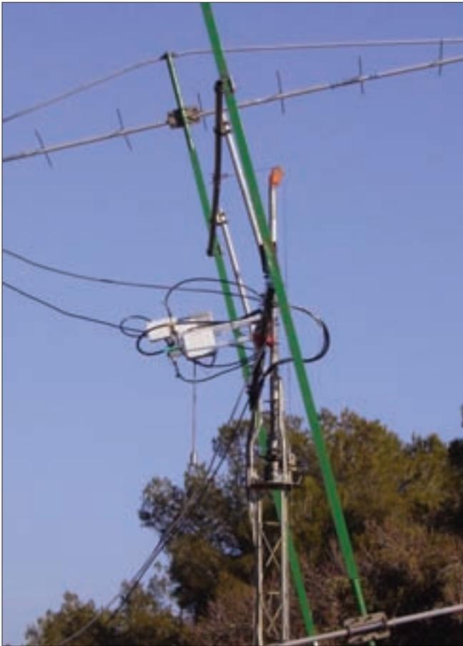
*El sistema de elevación, simple y efectivo, mediante una polea en el extremo del mástil y un pequeño polipasto es una "patente" de EA3BB. El contrapeso que desciende desde la caja del relé acciona un potenciómetro que indica la elevación del conjunto.*
