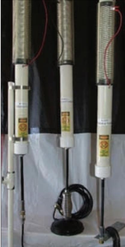
Foto L. Tres posibles montajes de la antena de Frank, KL7IPV. Es ligera, sencilla de instalar y transportar, y de fácil utilización.
