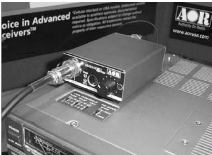
El módem para voz digital ARD9000 MK2 de AOR emplea el *vocoder* AMBE y corrección de errores FEC, permitiendo que cualquier equipo de radio con SSB pueda operar con voz digital, robusta y sin ocupar más ancho de banda que una señal de SSB analógica.
