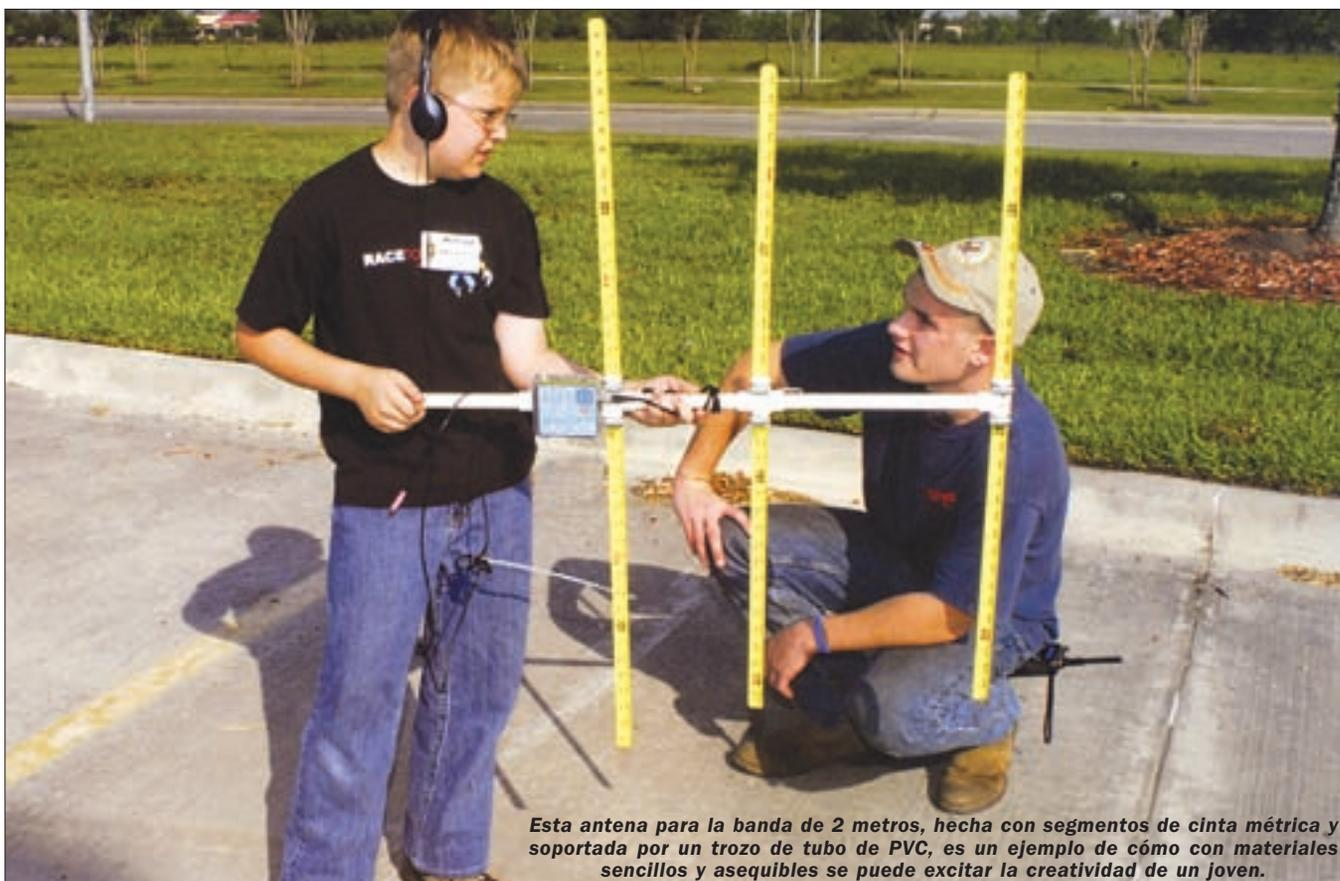
*Esta antena para la banda de 2 metros, hecha con segmentos de cinta métrica y soportada por un trozo de tubo de PVC, es un ejemplo de cómo con materiales sencillos y asequibles se puede excitar la creatividad de un joven.*
