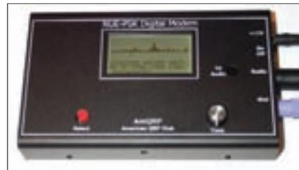
Foto F. Módem digital NUE-PSK adecuado para operación portable en PSK31 (ver texto). Junto con un transceptor de SSB y un teclado convencional PS2, el NUE-PSK forma una estación eficiente, compacta y portátil para operar PSK31.
