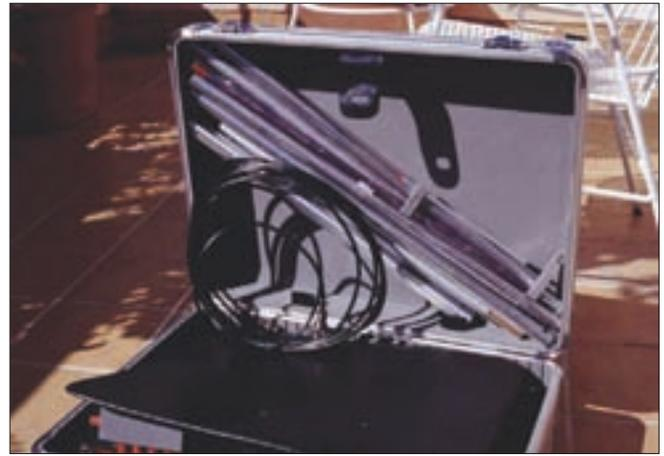
Foto D - La antena, partida en secciones de 55 cm, cabe justa en el espacio disponible en la tapa de la maleta.
