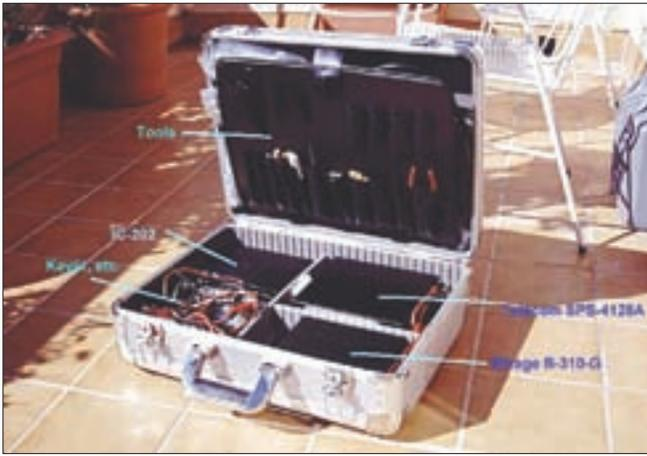
Foto C - Cuatro compartimientos para la electrónica y la tapa para la antena alojan todo lo necesario para salir al aire desde cualquier lugar.
