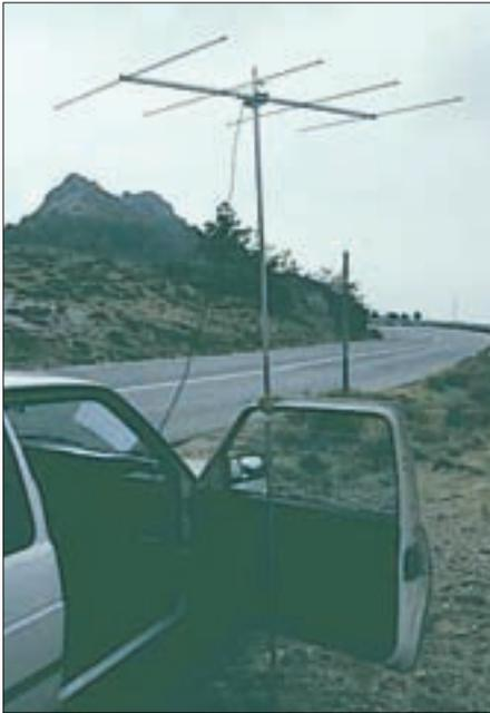
Foto F - Todo a punto para ensayar el DX en VHF. Un recodo de carretera, lejos de fuentes de ruido eléctrico y con horizonte despejado, basta como QTH.
