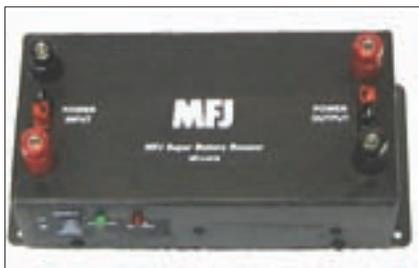
Foto G. El regulador de batería MFJ-4416 elimina los problemas de voltaje insuficiente incrementándolo hasta 13,8 V si se desea.
