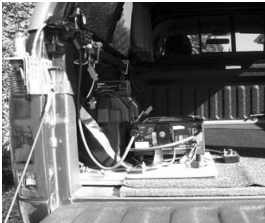
Foto F. Como dice W7ALA, "La vida es demasiado corta para el QRP", así que la instalación en su monovolumen incluye un amplificador de 500 W y una batería extra, todo montado en el maletero.
