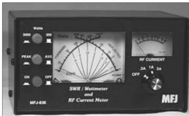
Foto D. El medidor MFJ-836 es un “todo en uno” que incluye amperímetro de RF, medidor de ROE y vatímetro direccional. Con este dispositivo puedes determinar la impedancia de la antena reflejada por el coaxial y vigilar si se producen cambios desfavorables en tu sistema de antenas. (Foto cortesía de MFJ)
