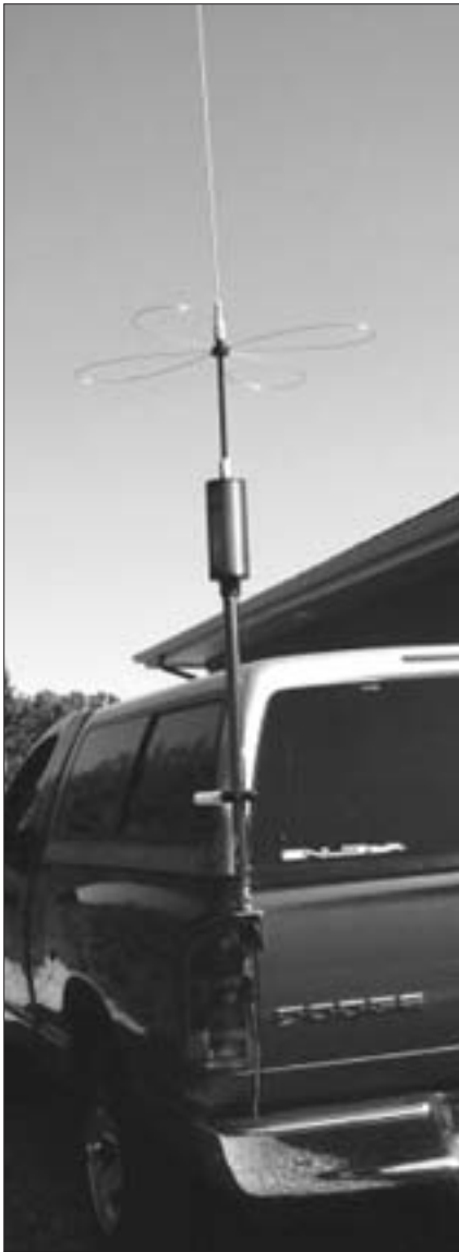
Foto B. Instalar una antena móvil significa encontrar un equilibrio entre mantenerla lo bastante baja para que sea sólida y segura y lo bastante alta para que la bobina sobresalga de la carrocería.
