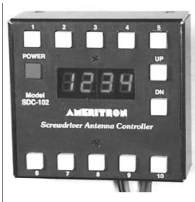
Foto B. El controlador programable Ameritron SDC-102 es un gran accesorio para antenas móviles que te permite almacenar 10 posiciones del tornillo sinfín que sintoniza una antena Screwdriver. ¿Más detalles? Búscalos en el texto. (Foto cortesía de Ameritron)
