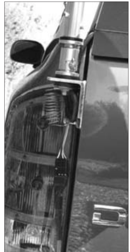
Foto C. El autor montó esta antena móvil justo encima del piloto trasero izquierdo, fijada en el marco del portón trasero.
