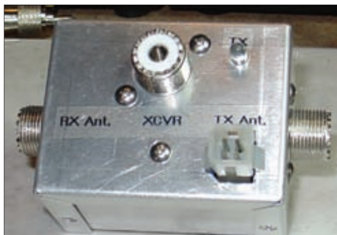
Foto B. Vista exterior del conmutador, al que se le añadieron los rótulos con letras adhesivas en negro.
