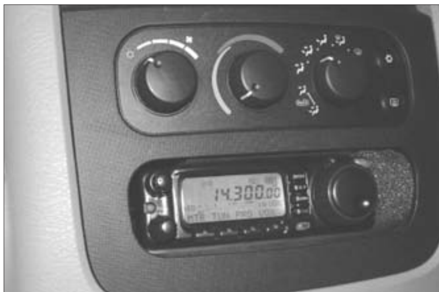
Foto A. En los atestados coches de hoy, es mucho mejor instalar un panel remoto que toda la radio.
