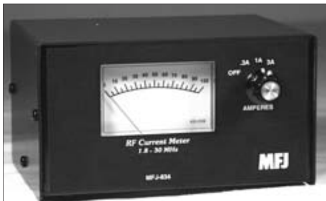
Foto C. El MFJ-834 es un amperímetro de RF para intercalar en el cable coaxial que puede permanecer conectado entre tu antena y el acoplador o el transceptor o el amplificador lineal para medir la corriente en el cable de bajada en tres escalas. Puedes utilizar el MFJ-834 para determinar los mejores ajustes para el acoplador y comparar el resultado de cada uno. (Foto cortesía de MFJ)
