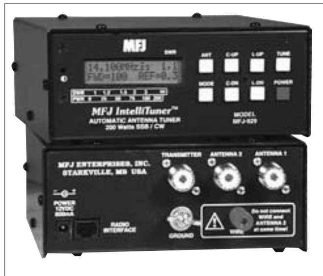
Foto E. El MFJ-929 IntelliTuner-Compact, es un acoplador con un sistema de memorias exclusivo VirtualAntenna, que te permite sintonizar tu antena automáticamente, tanto en el coaxial de bajada o aunque sea un hilo largo, en el margen de 1,8 a 30 MHz. Más detalles en el texto. (Foto cortesía de MFJ).
