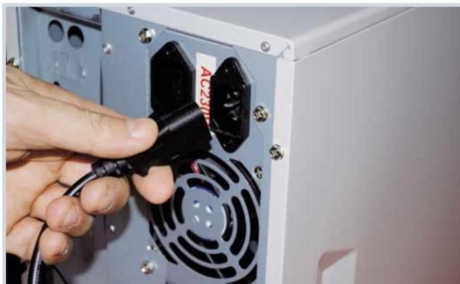
**1** Prima di avventurarsi all'interno di uno chassis di computer, è sempre meglio scollegare l'apparecchiatura dalla rete elettrica, staccando fisicamente il cavo di alimentazione. Ricordatevi di impugnarlo dalla spina - non va "tirato".
