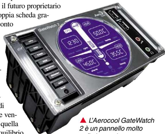
▲ **L'Aerocool GateWatch 2** è un pannello molto sofisticato, che occupa ben due baie da 5,25". Può controllare in modo indipendente le ventole poste in quattro zone del computer (suddivise in CPU, grafica, chassis e dischi) ed è provvisto di sensori tachimetrici e di temperatura. Dispone anche di porte USB e audio aggiuntive
