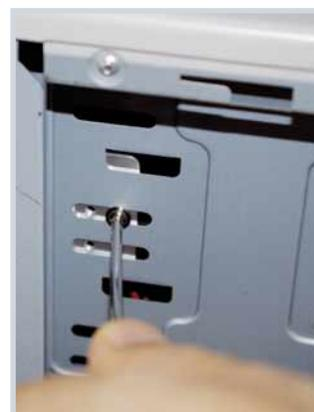
**10** È il momento di fissare il pannello di regolazione allo chassis. Poiché si tratta di un dispositivo sul quale si deve operare di frequente, è importante che il fissaggio sia stabile. Quindi, allineate bene il frontale del regolatore al resto dello chassis, e bloccatelo in posizione con due viti da ciascun lato. Mentre avvitate, tenete d'occhio il pannello per evitare che si sposti.
