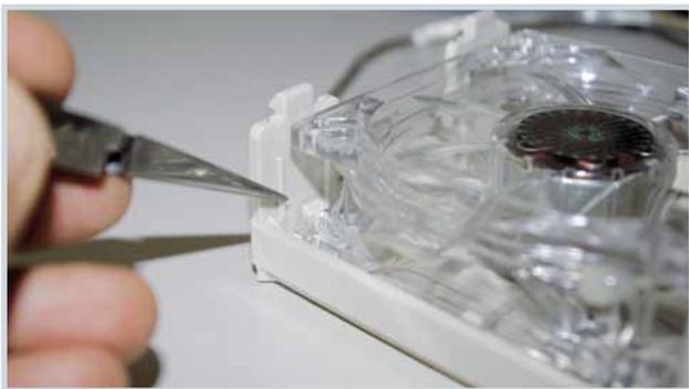
**13** Nella gabbia, la ventola è tenuta in posizione da due perni e due incastri; quelle che vengono fissate allo chassis di solito vanno invece fermate con 4 viti apposite, che normalmente vengono fornite nella confezione della girante. Un buon fissaggio è fondamentale per evitare vibrazioni.
