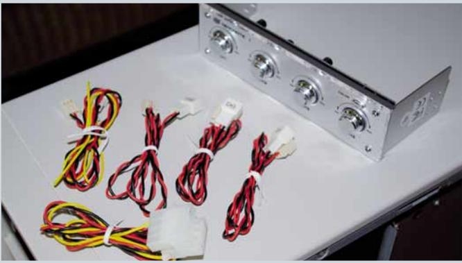
**6** Questo è il regolatore da installare. In primo piano i relativi cavi: uno per l'alimentazione, e quattro diretti alle ventole. Il cavo del canale 1 ha due connettori, e può quindi controllare in parallelo due ventole. Possono essere una di ingresso e una di uscita, oppure due ventole d'ingresso accoppiate.
