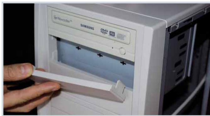
**4** I pannelli di regolazione di solito possono essere montati una baia da 5,25", come quella per i masterizzatori. In questo caso vogliamo installare il dispositivo nella baia sotto il masterizzatore, quindi apriamo la baia togliendo il coperchio protettivo che è fissato a incastro.
