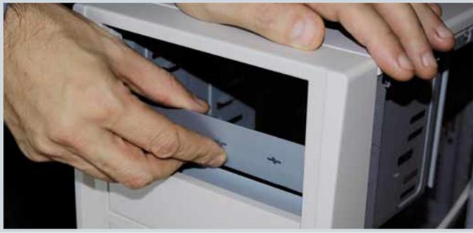
**5** Se la baia non è mai stata usata, è possibile che risulti chiusa anche da un pannello metallico interno, fissato al resto del telaio in due punti alle estremità. Per levarlo, basta piegarlo avanti e indietro alcune volte con le dita. Dovreste sentirlo cedere gradualmente. Procedete lentamente per ottenere uno stacco pulito.
