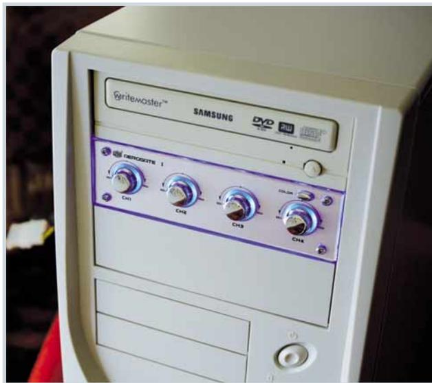
**15** Ecco come appare il frontale del PC una volta terminato l'intervento. L'aerogate permette di illuminare il pannellino di regolazione con tre diversi colori, che cambiano al semplice tocco del pulsantino visibile appena sopra la manopola di regolazione del canale 4.
