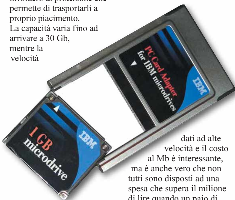
IBM Microdrive contiene 1 Gb di dati in uno spazio grande come una moneta
