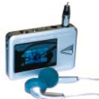
dispositivo cuenta con una memoria de 128 Mbytes, suficiente para almacenar 8 horas de música, pero si no nos parece suficiente podemos ampliarla mediante tarjetas MMC o SD. El reproductor i-Move 505 cuenta con una batería de litio recargable con una duración de 14 horas.
