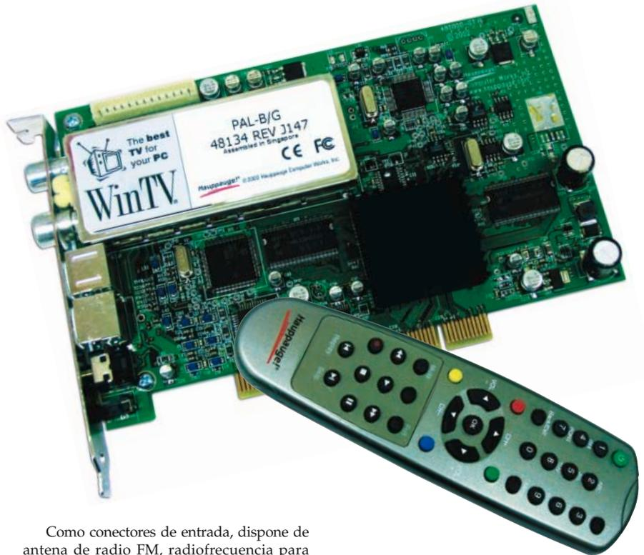
Como conectores de entrada, dispone de antena de radio FM, radiofrecuencia para televisión, entrada compartida por vídeo compuesto y S-Vídeo, entrada de sonido estéreo para cuando empleamos esta última y un conector para infrarrojos, de manera que podemos emplear las características de televisión con el mando a distancia incorporado. Como salida, proporciona un conector especial al cual colocamos el cable incluido que nos ofrece salida de audio estéreo, vídeo compuesto y S-Vídeo.
