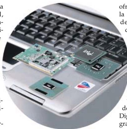
un soporte para memoria DDR2 de doble canal y el acelerador de gráficos Graphics Media Accelerator 900. En el apartado referente a la conectividad, Intel ha apostado por los procesadores inalámbricos integrados PRO/Wireless 2915ABG que
