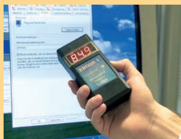
Este aparato se emplea para medir la frecuencia de refresco.
