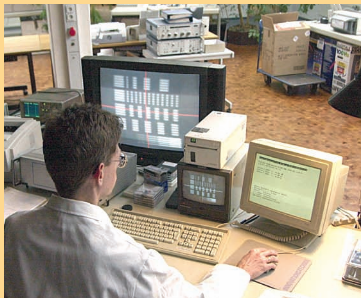
Uno de los técnicos del laboratorio compara la imagen obtenida a partir de la salida digital de una de las tarjetas del test, con el patrón de referencia.
