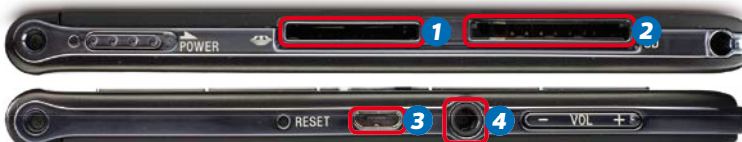
En la parte superior cuenta con dos ranuras para tarjetas, una Memory Stick 1 y otra SD 2. Abajo: la conexión micro USB 3 y la toma para cascos 4.
