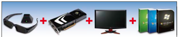
Para disfrutar del 3D de nVidia en tu PC es necesario: un kit de gafas, una tarjeta gráfica compatible, un monitor que funcione a 120 Hz y Windows Vista o 7.
