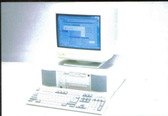
Concerto é o novo computador multimídia da Markvision (011- 857-0133), equipado com chip 5X86 da Cyrix, que chega ao mercado para competir com os dhip Pentium. Equipado com hard disc da Quantum, com 8Mb de RAM e Windows 95 instalado, o Concerto tem placa de fax/modem de 14.400 bps, drive de CD ROM de quádrupla velocidade e caixas de som embutidas no gabinete. O preço médio é de R\$ 2.200,00.
