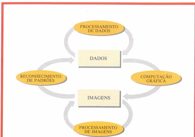
Fig. 1. Áreas correlatas. No procedimento tradicional, o computador recebe dados, faz algum tipo de processamento e devolve na saída dados de mesma natureza. É o que ocorre, por exemplo, no controle de contas bancárias: a entrada de dados é formada por valores positivos (créditos) ou negativos (débitos) que, depois de processados, têm como resultado o saldo atualizado do cliente. Na computação gráfica, os dados de entrada são transformados em imagem através de algum dispositivo de saída gráfica. Aproveitando o exemplo anterior, os dados poderiam ser os valores dos saldos de uma conta bancária, mas o objetivo seria produzir gráficos que mostrem a variação diária em um mês determinado. No processamento digital de imagens, o computador tem como entrada uma imagem e a saída é outra imagem. Exemplo bastante atual de aplicação de técnicas dessa área é a 'colorização' de filmes em preto e branco: a entrada é uma imagem monocromática e a saída é a mesma imagem, porém colorida. As técnicas da área de reconhecimento de padrões permitem obter, a partir de uma imagem (entrada), informações geométricas e topológicas sobre os modelos que deram origem a essa imagem. Um exemplo está na robótica: nas linhas de montagem automatizadas, os robôs utilizam informações extraídas de imagens provenientes de uma câmara para identificar as peças que serão manipuladas.
