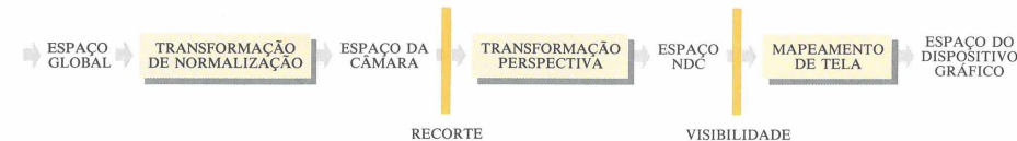
Fig. 10. Transformações de visibilidade. Uma série de transformações convertem o sistema de coordenadas a que os modelos estão associados, de modo que certas operações de visualização possam ser realizadas de forma mais conveniente. Assim, os objetos descritos num sistema local de coordenadas são transformados para o espaço global da cena durante a modelagem. Em seguida, a transformação de normalização os leva para o espaço da câmara em que o plano de projeção está associado ao plano xy do espaço euclidiano e a linha de visão ao eixo z . Neste sistema de coordenadas, o volume de visão corresponde a um sólido canônico próprio para a operação de 'recorte' (clipping), que seleciona os objetos interiores ao campo de visão da câmara virtual. Esses modelos irão passar pela perspectiva que deforma a geometria em função das distâncias relativas ao centro de projeção. Isto faz com que os objetos próximos apareçam maiores que os distantes. Dadas as suas características, esse espaço normalizado é o ideal para o cálculo da visibilidade, pois o problema se reduz à comparação da profundidade entre os elementos de cada superfície. O passo final é mapear os pontos visíveis dos modelos para as coordenadas do dispositivo de exibição, onde os pontos da imagem serão coloridos de acordo com as intensidades determinadas pelo cálculo da iluminação.
