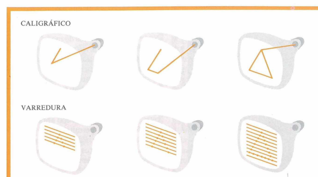
Fig. 2. Dispositivos caligráficos e de varredura. Nos dispositivos do tipo varredura, o feixe de elétrons 'varre' cada linha horizontal sucessivamente, numa frequência de 30 vezes por segundo. Cada ponto da tela ( pixel ) que pertence à imagem a ser mostrada é ativado quando o feixe de elétrons varre a linha horizontal a que ele pertence. Nos dispositivos caligráficos, o feixe de elétrons se desloca ao longo dos segmentos sucessivos que constituem a figura, de acordo com as instruções que foram armazenadas na lista de display . Esse processo ocorre também numa frequência de 30 vezes por segundo, de modo a criar uma imagem estável na tela.
