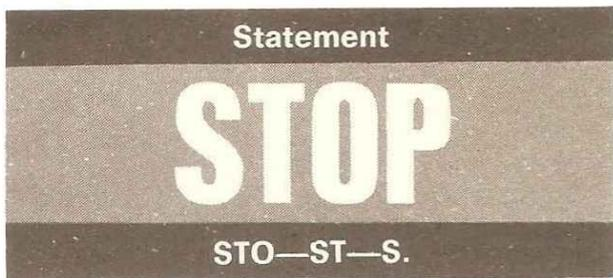
STOP é usado para parar a execução de um programa e colocar o computador em modo imediato. Ele pode ser colocado em qualquer ponto de um programa, mas não é normalmente usado no lugar do END.
