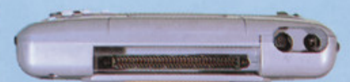
上部にはA/V出力端子とACアダプタ端子(共にMD2と共通)、カートリッジスロットがある。
