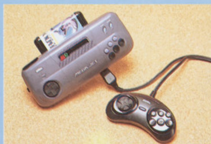
上部にはA/V出力端子とACアダプタ端子(共にMD2と共通)、カートリッジスロットがある。
