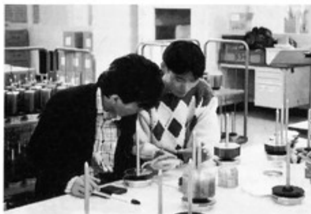
プロから目視検査を伝授されるトメ。目視検査は電氣的検査の済んだCDの外観、仕上がり人間目検査する細かい作業。
