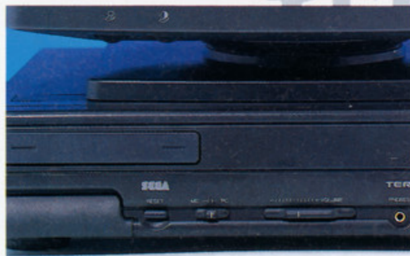
テラのフロントパネルにあるMD/PC切替スイッチで切り替える。
