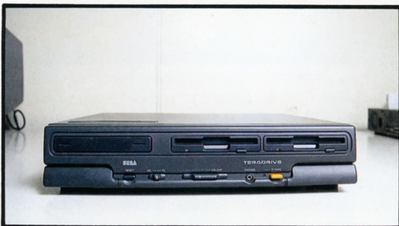
フロッピーディスクドライブを2基搭載したモデル
