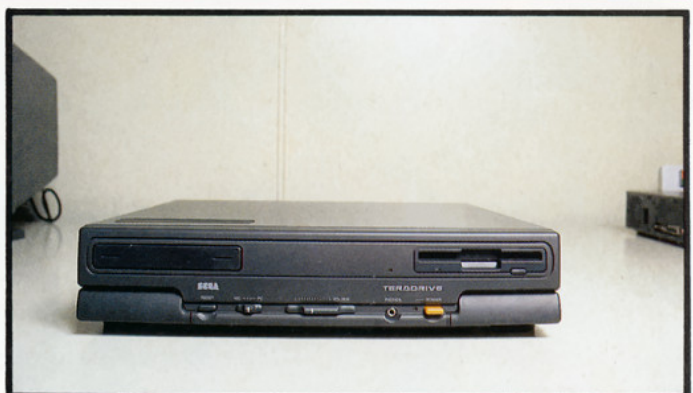
30Mバイトのハードディスクを搭載したパワフルなモデル
