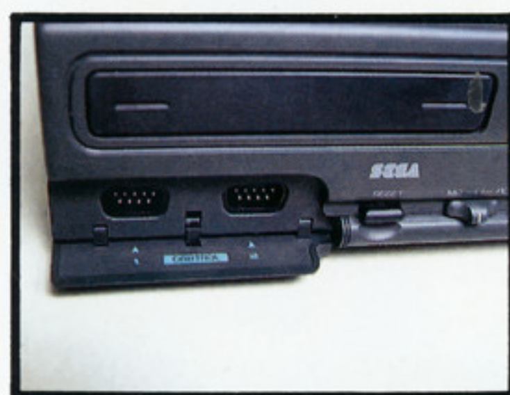
本体前面の左下にあるコントロール・パッド接続用コネクタ
