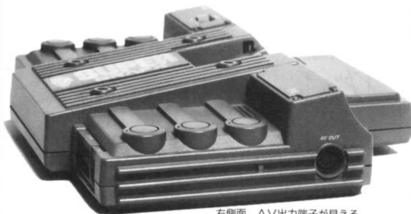
右側面。AV出力端子が見える
