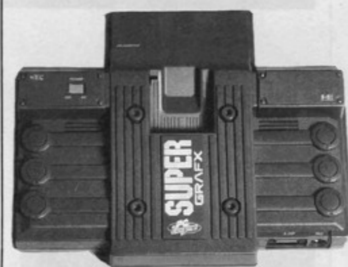
上部を見る。ROMカード挿入口と小さく電源スイッチが見える。
