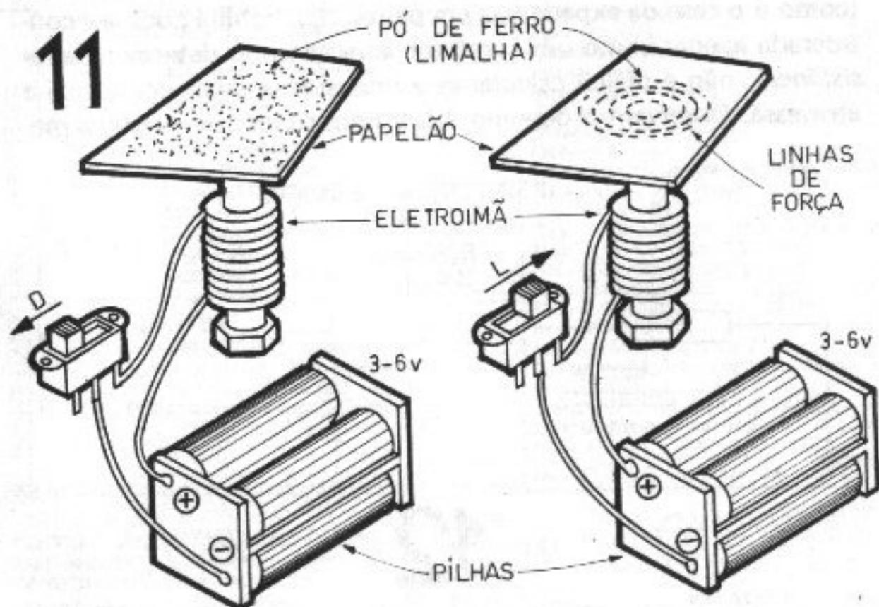
pelo campo magnético gerado pela passagem da corrente elétrica, na exata forma das *linhas de força* desse campo, assumindo uma série de linhas concêntricas e circulares, em torno da posição ocupada pelo polo do eletroímã (ponta do parafuso de ferro). Com isso você terá a oportunidade de "ver" as linhas de força do campo magnético, comprovando a sua existência e força.
