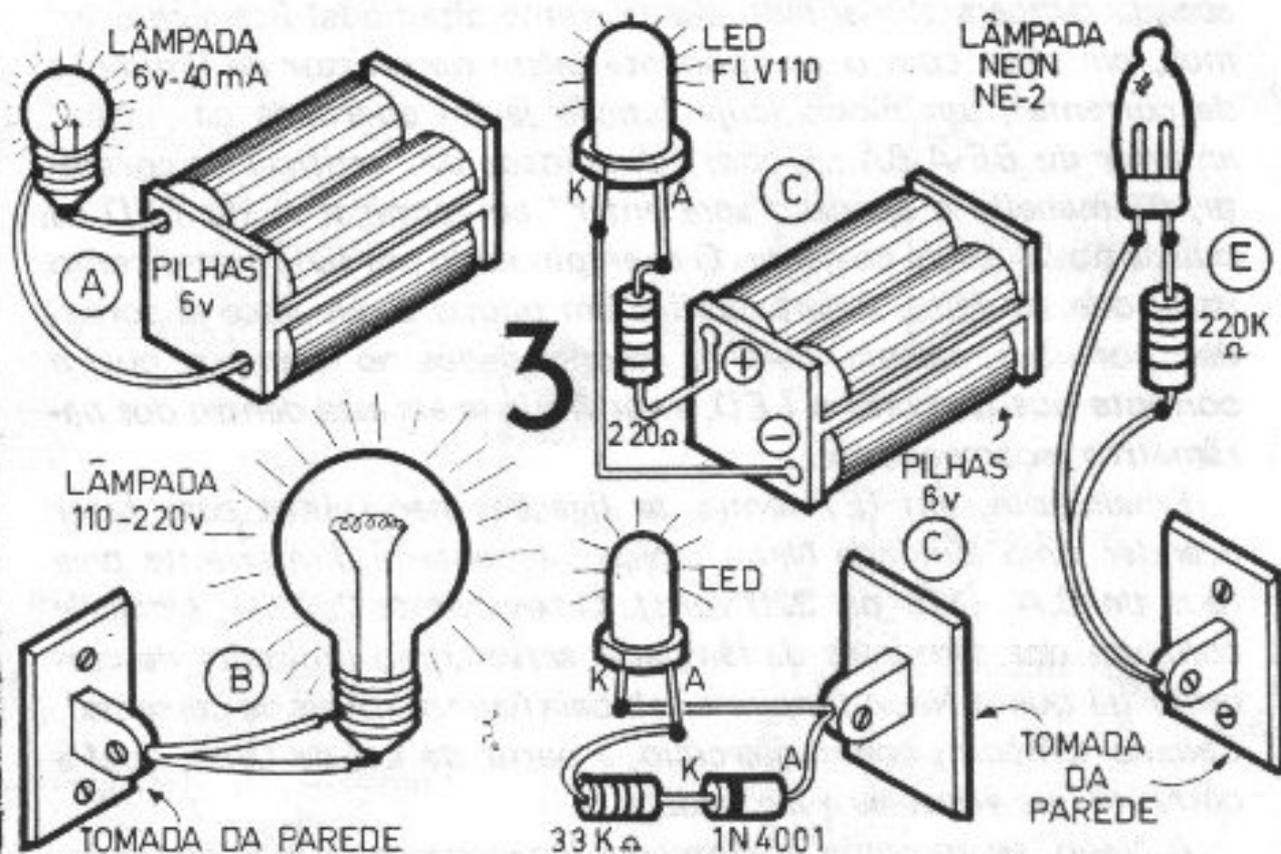
Em (C) vemos como fazer um LED acender, alimentado com pilhas. A maioria dos LEDs utilizados nas montagens Eletrônicas emite plena luminosidade quando percorrido por uma corrente de até 40 miliampéres (0,040 A). Se a corrente exceder esse parâmetro, o componente pode "soltar fumaça e pifar". Graças à Lei de Ohm, podemos calcular o valor de um resistor que deve ser colocado em série com o LED, para limitar a corrente fornecida pelas pilhas a um valor razoável, capaz de gerar boa luminosidade, po-
