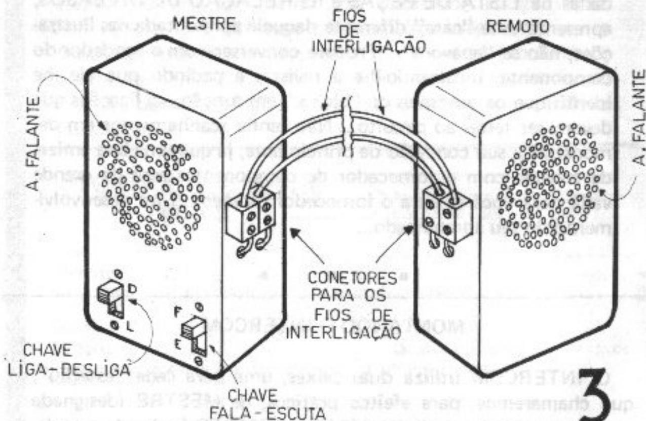
As furações das caixas estão mostradas no desenho 3, e as formas de fixação dos componentes que ficam diretamente presos aos "containers", estão no desenho 4. Ao fixar os alto-falantes com o adesivo de *epoxy*, é importante evitar que a cola atinja o cone de papelão desses componentes, pois isso poderá prejudicar o seu funcionamento (e até inutilizá-los, completamente...).
