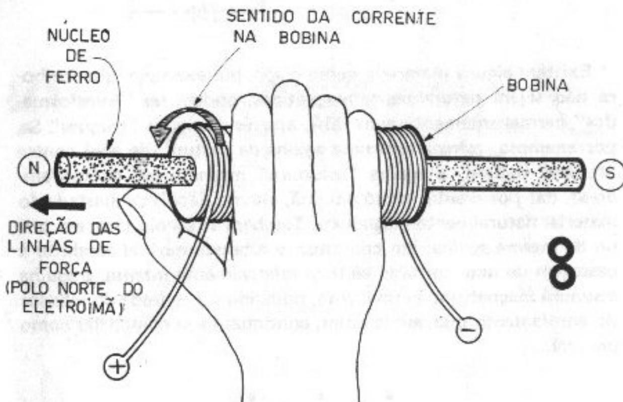
Esse eletroímã comporta-se de idêntica maneira à de um imã natural, com seus polos de nome igual repelindo-se e os de nome diferente atraindo-se. O desenho 9 mostra, ao alto, o comportamento de um imã natural em relação à agulha de uma bússola, e o correspondente comportamento de um eletroímã.
