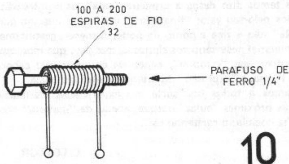
Convém recobrir o enrolamento, depois de pronto, com uma camada de fita adesiva ou fita isolante, para prender bem as espiras, evitando que o fio se desenrole. As duas extremidades do fio usado
