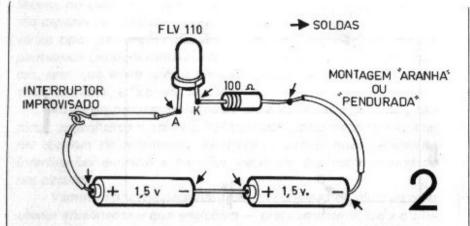
nais soldados aos demais "companheiros" do circuito. Nesse tipo de montagem, até certos tipos de componentes "periféricos" podem ser — literalmente — improvisados no momento da montagem (como é o caso do "interruptor" — desenho 2 — feito com dois ganchos de fio, que podem ser "encaixados" ou não, provendo a "ligação" ou o "desligamento" do circuito...).
