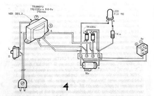
pela ordem (1, 2, 3 e 4), para evitar erros e esquecimentos. Sempre que tiver alguma dúvida sobre a correta posição ou identificação dos terminais dos componentes (principalmente do transformador, diodos, LED e capacitor eletrolítico), torne a consultar os desenhos 1, 2 e 3...
