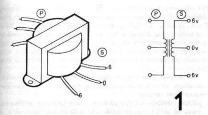
seis volts (6 V). Já no primário, pode ocorrer alguma confusão, pois existem transformadores que apresentam três ou quatro fios deste lado, codificados de maneira que o componente possa ser usado, indiferentemente, em redes de 110 ou 220 volts. Para que o "aluno" não tenha a menor dúvida quanto às ligações do primário, qualquer que seja o tipo de transformador que adquirir para montagem, o desenho 2 mostra tudo bem "mastigadinho"...
