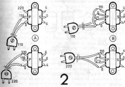
Em (A) vemos os dois esquemas de ligação, respectivamente para redes de 110 e 220 volts, para o caso de transformadores com *três* fios no *primário*. Em (B) aparecem as ligações a serem feitas, também para 110 ou 220 volts, no caso do transformador apresentar *quatro* fios no primário. Quanto ao *secundário*, nos dois casos deverá apresentar os idênticos três fios, conforme já explicado, não havendo problemas a serem resolvidos quanto à codificação dos fios.
