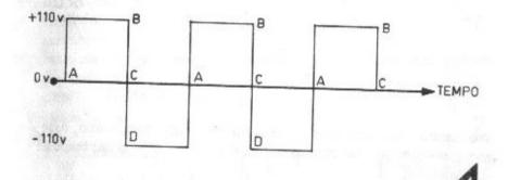
da mesma forma suave, novamente até o zero. A esse conjunto sequente de situações (do zero até o máximo de positivo, retornando ao zero, indo até o negativo e voltando novamente ao zero) dá-se o nome de UM CICLO. Notar, ainda no desenho 5, que tal CICLO pode ser dividido em duas metades, uma "acima do zero", que chamamos de SEMI-CICLO POSITIVO e outra "abaixo do zero"
