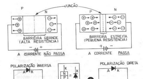
diodo formado pelos dois materiais semi-condutores está diretamente polarizado (ver o "esqueminha", em baixo, à direita...). No centro da parte inferior do desenho (dentro do círculo) aparece a esquematização de uma junção semi-condutora PN (diodo), ao lado do respectivo símbolo adotado para representá-la (ver novamente o desenho 1).
