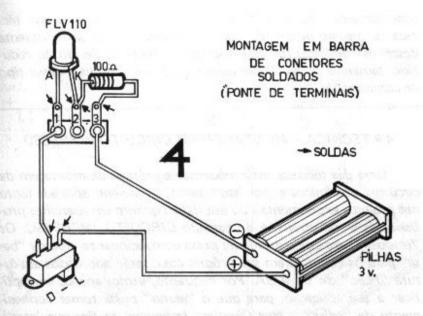
pria barra no interior de uma caixa, ou sobre uma base, é facilitada pela possibilidade de parafusá-la (através de furos apropriados, ou dos próprios ilhoses).
