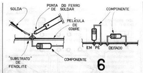
Vantagens — A principal vantagem dessa técnica é o tamanho extremamente pequeno com que os circuitos podem ser montados, possibilitando a sua instalação em caixas proporcionalmente reduzidas e de uso muito prático. O uso muito reduzido (ou nulo...) de fios de ligação (apenas são empregados nas conexões de componentes "periféricos" e "pesados"...) evita, quase que totalmente, a possibilidade de curtos acidentais ou da ruptura de ligações devido a vibrações, etc.
