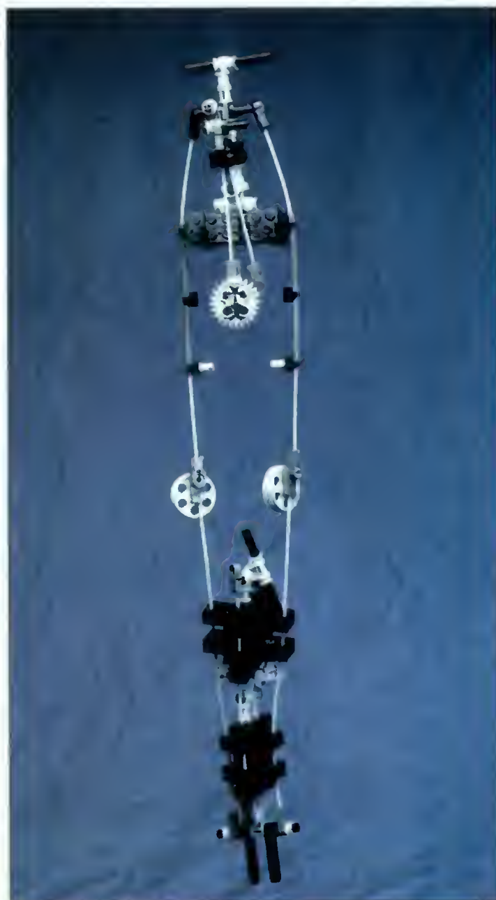
A to jest chyba „fatalcja” z dino LEGOzaura. System ściągania i stawów poruszających głowę i ogonem
