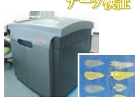
光造形機「エデン」は設計データを元に、光をあてると硬化する樹脂を使って試作品を作り出すスグレモノ! こうして設計されたモデルのデータは、金型ルームのCAMシステムに送られる。
