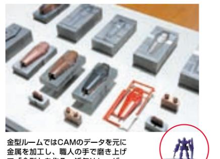
金型ルームではCAMのデータを元に金属を加工し、職人の手で磨き上げて「金型」を作る。近年はレーザー加工機を導入し、40ミクロンという微細な加工も可能になった。
