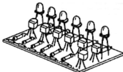
**Conjunto n.º 2.** Módulo de Leds composto de: 7 transistores NPN de uso geral, 6 leds, 6 diodos, 13 resistores. (Para se usar como tacômetro, voltímetro, termômetro, VU e etc...).
