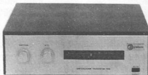
FM-5 — Sintonizador de frequência modulada de grande sensibilidade. Incorpora um efetivo "Contrôle Automático de Frequência" (AFC), que impede as variações de sintonia, tão comuns em aparelhos a válvula. Pode ser também fornecido com demodulador de Multiplex, ou no modelo FMR-10, com amplificador de 10 watts de potência e com controles de volume, graves e agudos.
