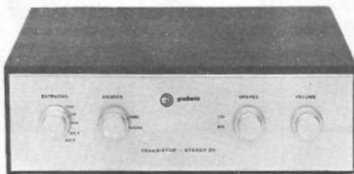
ST-20 — Amplificador estereofônico integrado (com amplificador de potência e pré-amplificador), "todo-transistor", de 20 watts de potência, com entradas para toca-discos (cápsula magnética ou cerâmica) e FM, além de entradas e saídas para gravador. Contrôles de volume, graves, agudos e seletor de entradas. Extremamente compacto, não necessita de ventilação podendo ser embutido em qualquer móvel.
