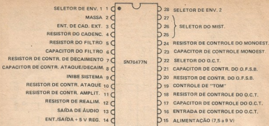
FIG. 2 — Função dos pinos do C.I. 76477.
