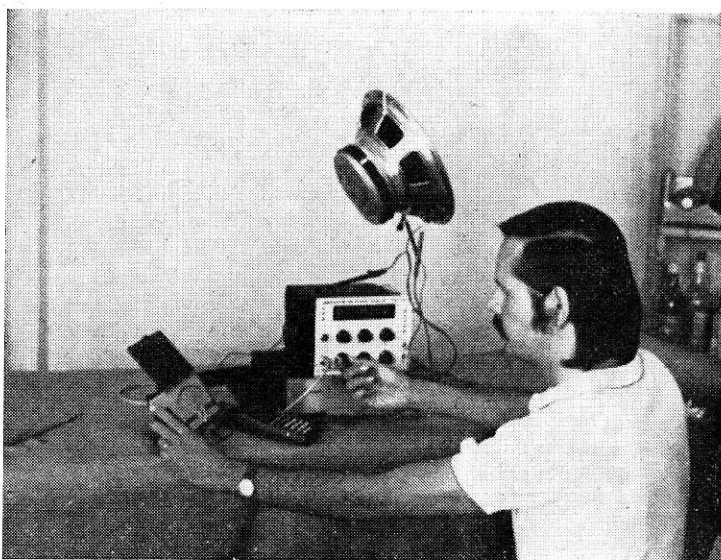
FOTO 1 — Determinação de f e Q_{T_s} . Vê-se o falante sob teste suspenso acima da bancada e longe de superfícies refletoras. À esquerda, miliamperímetro e voltímetro; ao centro, gerador de sinal e amplificador.
