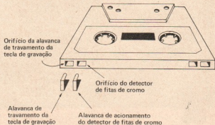
FIG. 2 — As novas fitas de cromo possuem um furo extra para o detector deste tipo de cassette.
