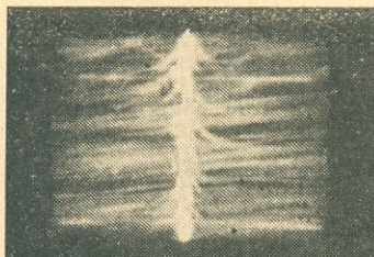
FOTO V — Com o brilho baixo, o chassi Zenith CTC63 produzia uma oscilação parasita, que se manifestava como uma linha irregular no centro da imagem.
