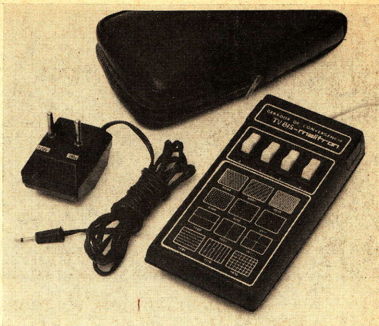
FOTO 1 — Este é o Gerador de Convergência TV-815, com a bolsinha plástica para o transporte, e a fonte de alimentação para redes de 110 e de 220 volts C.A.
