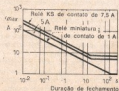
FIG. 3 — Corrente máxima de curta duração, I_{max} , circulante nos contatos de relés fechados, em função do tempo de fechamento, t_f .
