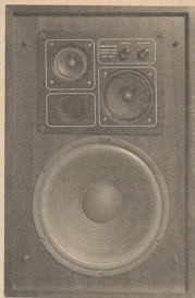
FOTO 1 — O LC-50 visto de frente, com a tela frontal removida. Um painel metálico engloba os falantes de médios e de agudos, os controles e o ducto.
