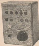
FOTO 1 — Aspecto da caixa que contém o circuito do provador de transistores. Os cinco diodos fotomissores (três para indicação de ganho e dois para indicação de tipo) são colocados na parte superior do painel frontal. Logo abaixo deles, da esquerda para a direita, as duas tomadas para alimentação externa e as três tomadas (emissor, base e coletor) do indicador de tipos. No centro, à esquerda, o sequele para transistores do indicador de ganho e, abaixo deste, o interruptor de pressão da alimentação. No canto direito, embaixo, o botão da chave de funções.
